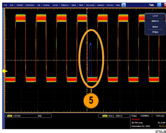
6. ステップ 5 で特定したグリッチでトリガするには、Glitch Setup... を選択します。
