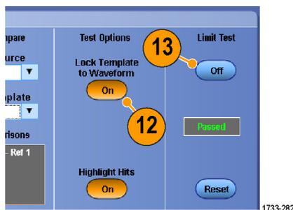
取り込まれた波形すべてがテンプレートと比較されます。この比較は、テンプレートと一致しない波形が見つかるまで行われます。テンプレートと一致しない波形が見つかったら、アキュジションが停止され、違反はディスプレイ上に違う色で表示されます。次の例では、Ch1、テンプレート、および取り込まれた波形ポイントを確認できるように、Ch 1 が上に表示されています。
