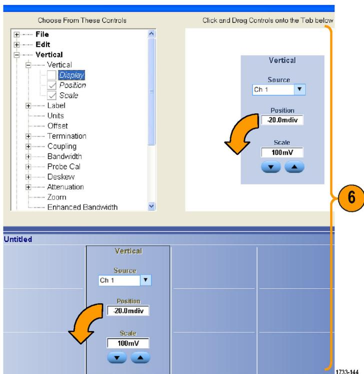
7. New Tab をクリックし、MyScope コントロール・ウィンドウにタブを追加します。最大 6 つのタブを設定できます。
