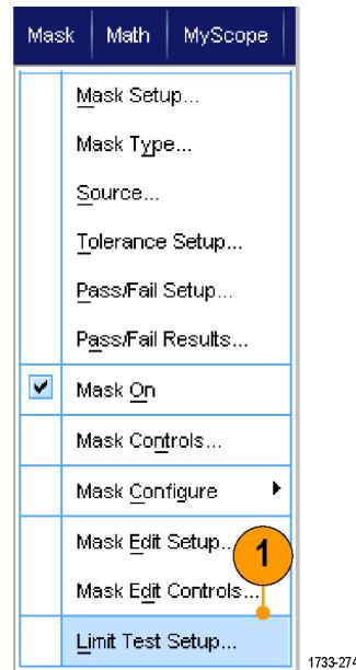
2. 选择 Source (源)、Destination (目标) 和 Tolerances (容限) 来创建模板。使用多功能旋钮调节 Tolerances (容限)。“容限”指定信号在极限测试中失败之前有多大的余量。
