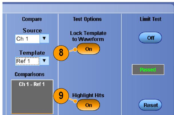
10. 将 Limit Test (极限测试) 切换为 On (开) 开始测试。
