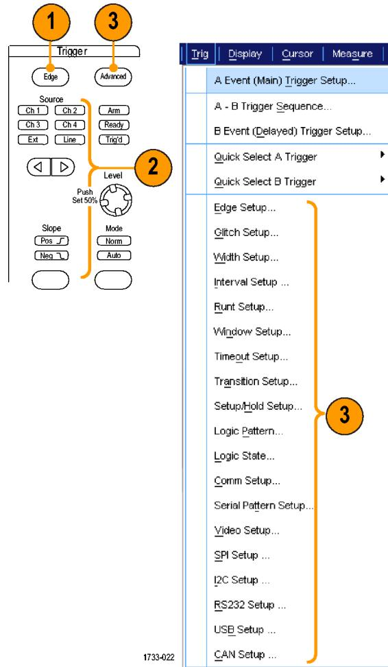
4. 使用为触发类型显示的控件完成触发设置。用于设置触发的控件将因触发类型不同而各不相同。
