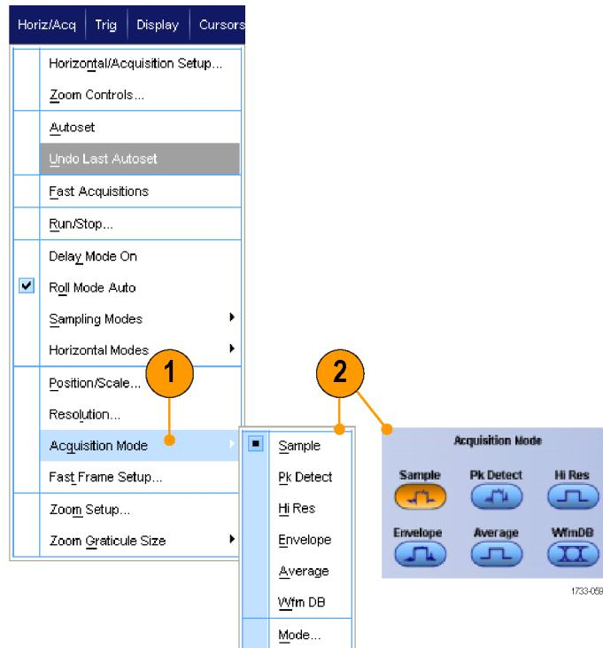
3. 对于“平均”或“包络”采集模式，请单击 **# of Wfms**（波形数）控件，然后使用多功能旋钮设置波形数。对于波形数据库模式，请单击 **Samples**（取样）控件，然后使用多功能旋钮来设置取样数。
