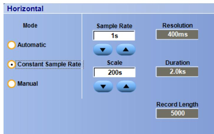
在 Manual (手动) 模式中，您可以设置 Sample Rate (取样速率) 和 Record Length (记录长度)。Horizontal Scale (水平刻度) 是由取样速率和记录长度计算出来的他变量。手动模式下不支持模板。Horizontal Scale (水平刻度) 旋钮更改手动模式下的记录长度。
