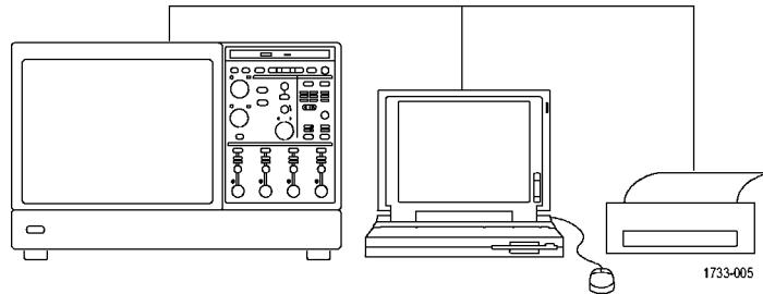
**说明：**要通过网络进行远程操作，请切换 Display（显示）>Display Remote（远程显示）为打开状态。必须在仪器及远程 PC 上安装 VNC 或 pcAnywhere。启用 Display Remote（远程显示）后，显示更新、控制窗口访问及菜单项将会变慢。
