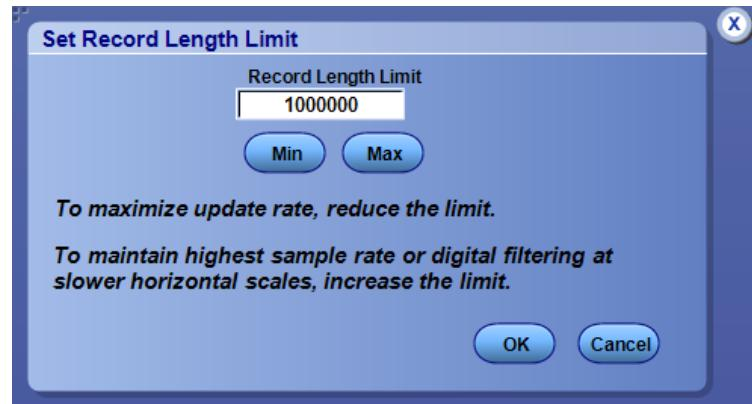
在 Constant Sample Rate（恒定取样速率）模式中，您可以设置 Sample Rate（取样速率）和 Scale（比例）。默认取样速率保证带宽过滤操作。记录长度不是独立变量。最大记录长度取决于您的仪器型号和记录长度选项。
