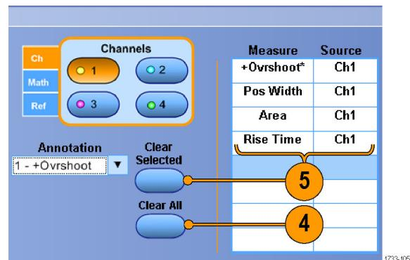
还可以直接在 **Measure** (测量) 菜单中为所选波形选择测量。
