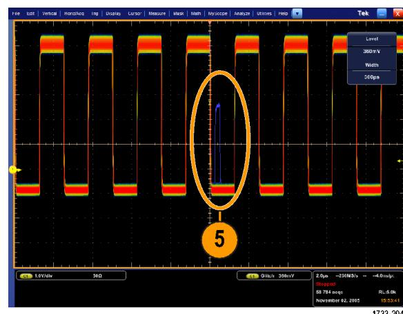
6. 要触发在步骤 5 中标识的毛刺，请选择 **Glitch Setup...**（毛刺设置...）。
