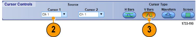
4. 要想在两个波形之间进行测量, 请选择 **Waveform** (波形), 然后选择每个光标的波形源。
