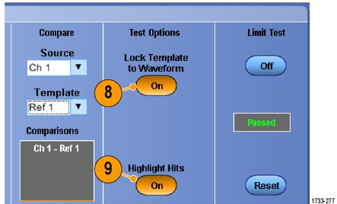
10. 将 **Limit Test** (极限测试) 切换为 **On** (开) 开始测试。
