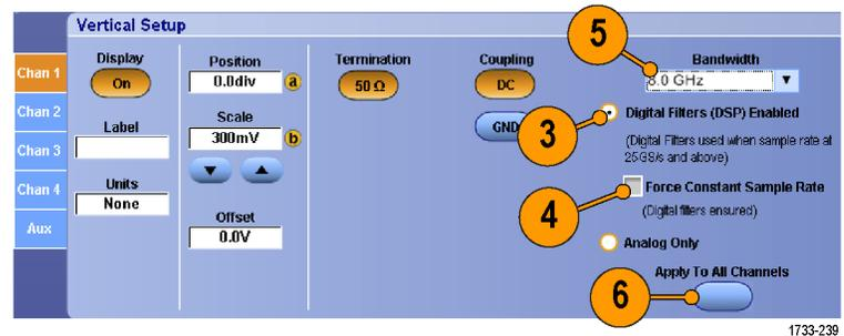
**说明：** 如果尚未设置，则选择 Constant Sample (恒定取样) 速率将水平模式设为恒定取样速率，将取样速率设置为允许 DSP，并选择一个 DSP 带宽。
