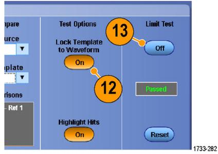
仪器将其采集到的每一个波形与模板进行比较, 直到波形匹配模板失败为止。当失败发生时, 采集停止, 屏幕上用不同的颜色显示违例。下面的例子将 Ch 1 显示在顶部, 这样您可看清 Ch 1、模板和命中点。
