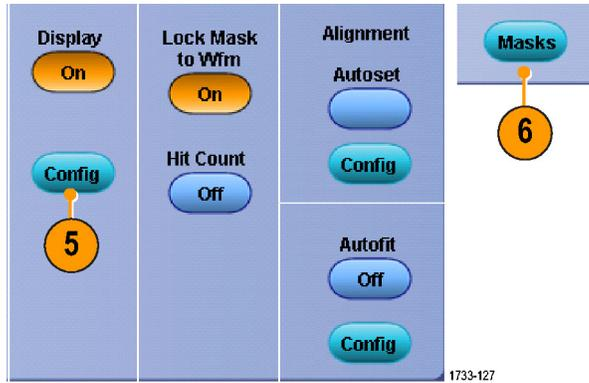
7. 单击 Lock Mask to Wfm (将屏蔽锁至波形) 使其变为 **On (打开)**, 以便跟踪屏蔽在水平设置或垂直设置上的更改。
