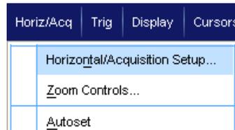
在 **Automatic**（自动）模式中，您可以设置 **Scale**（比例）和 **Sample Rate**（取样速率）。记录长度不是独立变量。如果改变比例将导致记录长度超过 **Record Length Limit**（记录长度限制），则取样速率将降低到下一个可用的设置。
