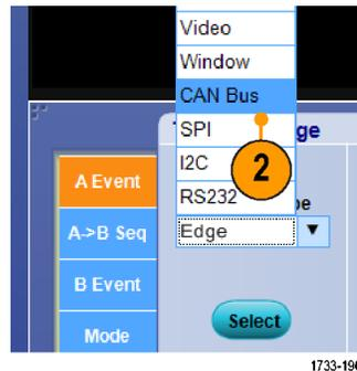
3. 选择 Trigger On（触发）以选择所需的触发功能。
