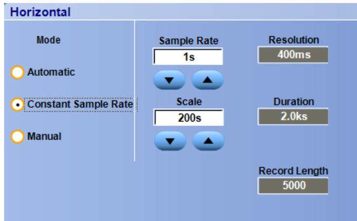
在 Manual（手动）模式中，您可以设置 Sample Rate（取样速率）和 Record Length（记录长度）。Horizontal Scale（水平刻度）是由取样速率和记录长度计算出来的他变量。手动模式下不支持模板。
