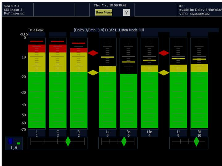
8. サラウンド表示を使用して、サラウンド・サウンド・リスニング環境でレンダリングされた、個別の要素の相対的な音量を監視します。右に示された性能パラメータおよびインジケータのサラウンド・サウンド表示をチェックします。インジケータについては、後の「使用上の注意」で説明します。
