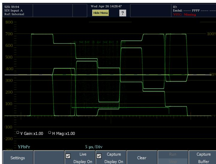
3. Buffer / Trace ソフトキーを押して Capture の種類を設定します。Close Settings を押して、サブメニューを終了します。
