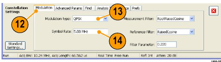
15. Установите в поле Measurement Filter (Измерительный фильтр) значение **RootRaisedCosine**.
