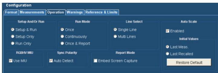
H 同期および V 同期で指定した極性は、タイミング規格によって異なるため、VM シリーズ・システムは、その極性を自動的に判断するために、H および V 同期信号を接続するように要求します。同期信号の極性が判断されると、測定サイクルが開始されます。“極性テスト”は、各測定サイクルの初めに実行されます。各測定サイクルの初めにこのテストを実行しないようにするには、Auto Detect を選択した状態で、測定を 1 回実行します。Auto Detect を選択した状態で 1 回の測定サイクルを実行すると、Auto Detect の選択を解除しても、極性テストのために信号を変えるように要求されなくなります (VM シリーズ・システムが同期信号の極性を記憶します)。被測定装置でフォーマットのセットアップを変更した場合は、必ず Auto Detect を選択した状態で、測定サイクルを完了してください。
