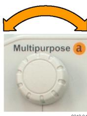
次に、汎用ノブ **b** を回して、オシロスコープで信号をロジック・ハイまたはロジック・ローと認識する境目となる電圧レベルを定義します。
