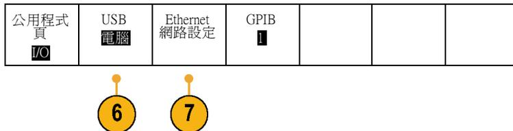
檢查下方斜面功能表的 USB，確定 USB 已啟用。如果尚未啟用，請按下 USB。接著，按下側邊斜面功能表的**連接至電腦**。
