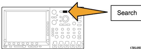
10. 按下**搜尋類型**。使用多功能旋鈕 **a**，選取**匯流排**，按下**資料**。使用多功能旋鈕 **a** 和 **b**，定義資料值。
