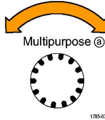
4. 若要移除測量，按下**移除量測**，旋轉多功能旋鈕 **a** 來選擇特定測量，並按下側邊斜面功能表上的**確定移除量測**。
