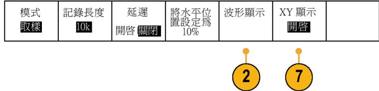
3. 按下側邊斜面功能表的**只顯示點 On Off**。開啓只顯示點，螢幕上就會以點顯示波形記錄點。關閉只顯示點，就會以向量連接這些點。
