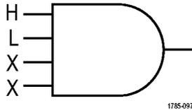
所有的波道轉為指定狀態時，進行觸發。使用多功能旋鈕 **a**，選取波道。按下適當的側邊斜面按鈕，將波道狀態設定為高 (H)、低 (L) 或 Don' t Care (X)。
