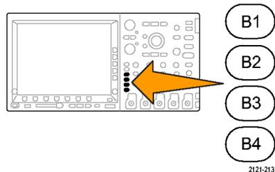
2. 按下 **匯流排**。旋轉多功能旋鈕 **a**，捲動匯流排類型清單，並選取所需要的匯流排：並列 (僅限 MSO4000 系列)、I<sup>2</sup>C、SPI、CAN、RS-232、LIN、FlexRay 或音訊。
