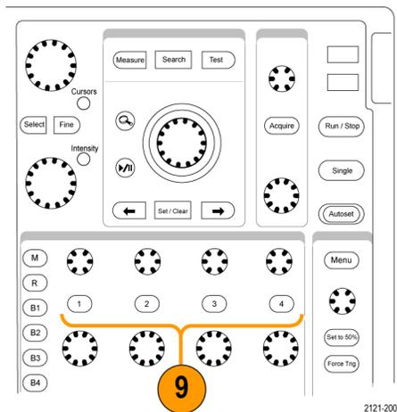
10. **B1** 或 **B2**。若您已設定模組應用程式按鍵，按下此按鈕則可定義並顯示匯流排。DPO4AUTO 模組支援 CAN 與 LIN 匯流排。DPO4AUTOMAX 支援 CAN、LIN 與 FlexRay 匯流排。DPO4EMBD 模組支援 I<sup>2</sup>C 和 SPI。DPO4COMP 模組支援 RS-232、RS-422、RS-485 與 UART 匯流排。DPO4AUDIO 模組支援 I<sup>2</sup>S、左端對齊 (LJ)、右端對齊 (RJ) 和 TDM 匯流排。
