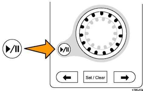
3. 反向您旋轉飛梭旋鈕的方向，就可以改變播放方向。
