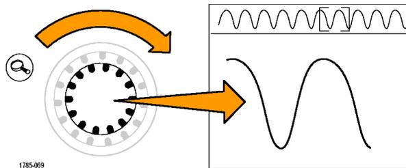
2. 旋轉**縮放**旋鈕，將縮放方塊的中心放在靠近繼電器觸點開始張開的位置。
