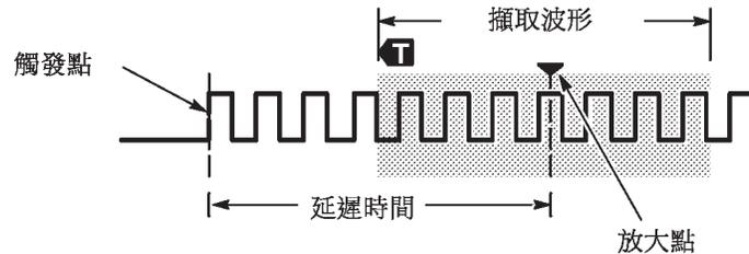
將**延遲**設定為**開啓**狀態時，逆時鐘方向旋轉**水平位置**旋鈕以增加延遲。觸發點將移至左側，最後還會移出所擷取的波形之外。接著，您可以調整**水平刻度**旋鈕，針對您感興趣的螢幕中央處區域擷取更多細節。
