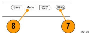
8. **Save/Recall 메뉴**. 내부 메모리, CompactFlash 카드 또는 USB 플래시 드라이브를 사용하여 설정, 파형 및 화면 이미지를 저장하거나 호출하려면 이 버튼을 누릅니다.
