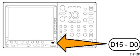
4. D15-D0 On/Off 하단 베젤 버튼을 누른 다음 D7-D0 켜기 사이드 베젤을 눌러 디지털 파형을 표시합니다. 채널을 끄려면 범용 노브 a를 사용하여 채널을 선택하고 디스플레이 사이드 베젤을 눌러 Off를 선택합니다.
