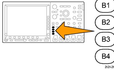
6. 버스 표시 하단 베젤 버튼을 누르고 버스 및 파형 사이드 베젤 버튼을 누른 다음 ASCII 사이드 베젤을 누릅니다.
