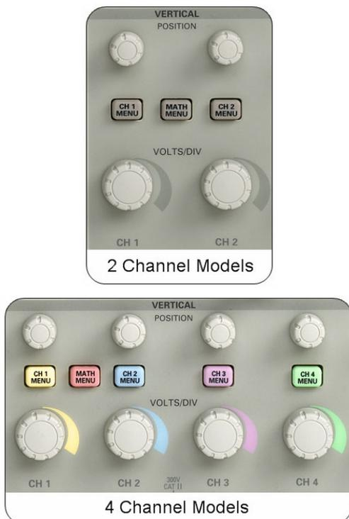
**Figure 2.8: TDS1001B and TDS2024B VERTICAL controls**
