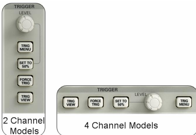
**Figure 2.13: TDS1012 and TDS2024 TRIGGER controls**
