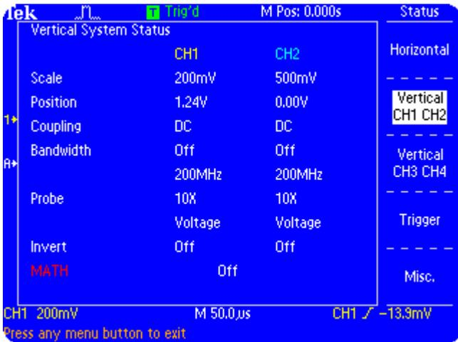
**Figure 6.16: TDS1000B/TDS2000B Vertical System Status display**
