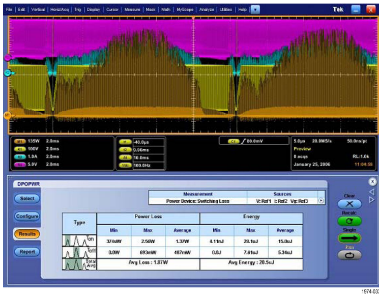
图 3：开关损耗结果显示
