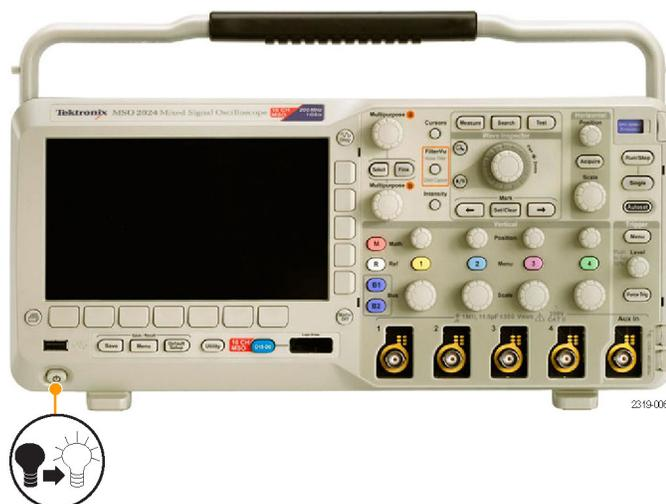
3. Schließen Sie die Tastkopfspitze von Tastkopf TPP0200 und den Referenzleiter an die **PROBE COMP**-Anschlüsse am Oszilloskop an.
