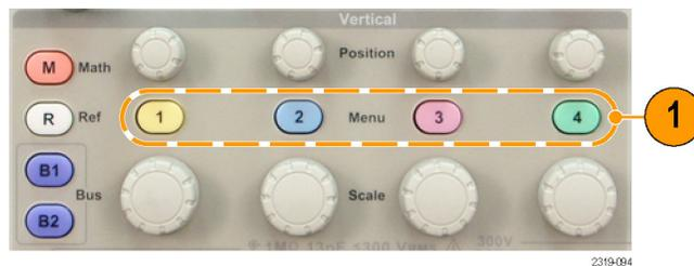
Durch Drücken einer Kanaltaste wird auch ein Signal ausgewählt oder diese Auswahl aufgehoben.
