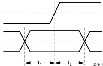
Sie triggern, wenn sich der Status eines logischen Dateneingangs innerhalb der Setup- oder Hold-Zeit relativ zu einer Taktflanke ändert.
