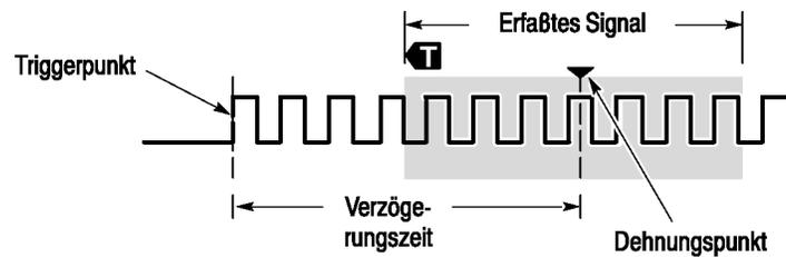
Wenn **Verzögerung** auf **Ein** gesetzt ist, drehen Sie den Drehknopf **Horizontale Position** in Gegenuhrzeigerrichtung, um die Verzögerung zu erhöhen. Der Triggerpunkt wird nach links und schließlich über das erfasste Signal hinaus bewegt. Anschließend kann der Drehknopf **Horizontalskala** auf eine detailliertere Erfassung um den betreffenden Bereich in der Bildschirmmitte eingestellt werden.
