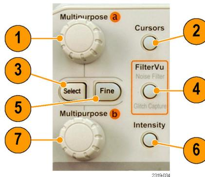
2. **Cursors.** Drücken Sie einmal, um die beiden vertikalen Cursor zu aktivieren. Drücken Sie die Taste noch einmal, um die beiden vertikalen und die beiden horizontalen Cursor zu aktivieren. Drücken Sie die Taste erneut, um alle Cursor zu deaktivieren. Wenn die Cursor aktiviert sind, können Sie ihre Position mit den Mehrzweck-Drehknöpfen steuern.
