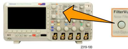
2. Stellen Sie mit dem Mehrzweck-Drehknopf **a** den Wert für **Störfilter (Vordergrund)** ein.
