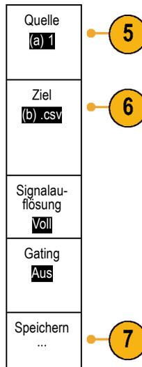
**Speichern eines Signals in einer Datei.** Wenn Sie die Taste **Ziel** auf dem seitlichen Rahmen drücken und Mehrzweck-Drehknopf **b** drehen, ändert sich das Menü auf dem seitlichen Rahmen. In der folgenden Tabelle werden die Optionen zum Speichern von Signaldaten in Dateien auf Massenspeichergeräten beschrieben.
