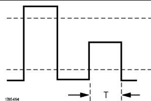
Trigger auf einer Impulsamplitude, die eine Schwelle überschreitet, eine zweite Schwelle jedoch nicht überschreitet, bevor die erste Schwelle erneut überschritten wird. Es können positive oder negative (oder beide) Runts erkannt werden, oder nur solche, die breiter als, kleiner als, größer als, gleich oder ungleich einer angegebenen Breite sind. Runt-Trigger werden primär für digitale Signale verwendet.
