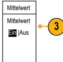
4. Drehen Sie den Mehrzweck-Drehknopf **a**, um die Anzahl der Signale einzustellen, aus denen der Mittelwert gebildet werden soll.
