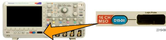
2. Um die Skalierung (Höhe) der digitalen Kanäle zu ändern, drücken Sie die Taste **Höhe** im Menü auf dem unteren Rahmen.
