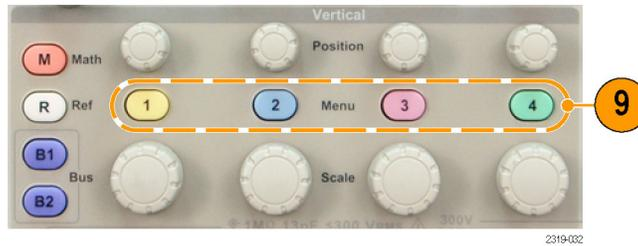
10. **B1 oder B2.** Drücken Sie eine Taste, um einen seriellen Bus zu definieren und anzuzeigen, wenn Sie über die entsprechenden Modulanwendungsschlüssel verfügen. Modul DPO2AUTO unterstützt CAN- und LIN-Busse. Modul DPO2EMBD unterstützt I<sup>2</sup>C und SPI. Modul DPO2COMP unterstützt RS-232-, RS-422-, RS-485- und UART-Busse. Bei Oszilloskopen der Serie MSO2000 ist Unterstützung für Parallelbusse verfügbar.
