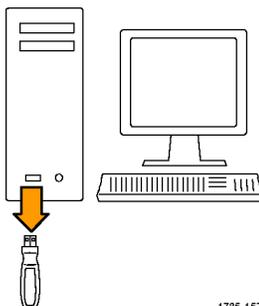
Entpacken Sie die Dateien, und kopieren Sie die Datei firmware.img in den Stammordner eines USB-Flash-Laufwerks.
