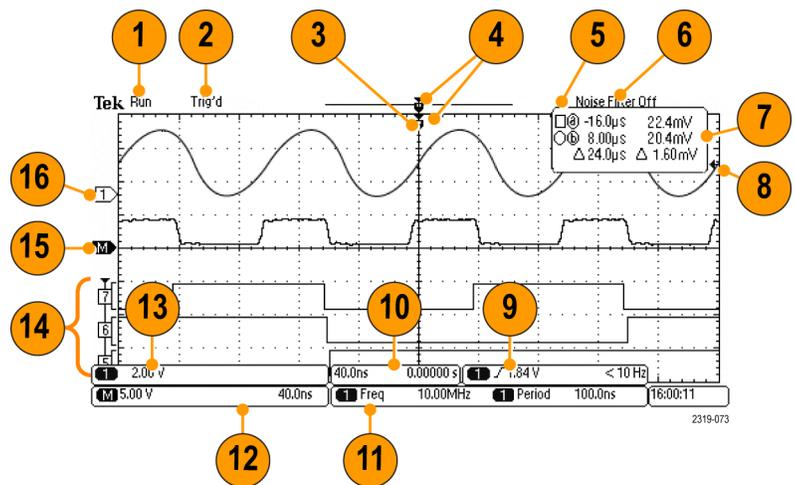
1. Die Erfassungs-Messwertanzeige wird eingeblendet, wenn eine Erfassung ausgeführt oder angehalten wird, oder wenn eine Erfassungs-Voransicht angezeigt wird. Die Symbole bedeuten Folgendes:
