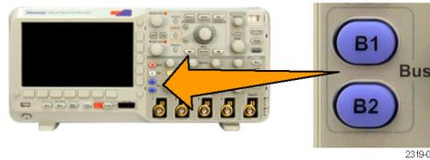
2. Drücken Sie **Bus**. Drehen Sie den Mehrzweck-Drehknopf **a**, um durch die Liste der Bustypen zu blättern und den gewünschten Bus auszuwählen: Paralleler Bus (nur Serie MSO2000), I<sup>2</sup>C, SPI, CAN, RS-232 oder LIN.
