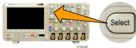
Zum Ändern der Bezeichnung können Sie bei Bedarf die Tasten auf dem unteren Rahmen verwenden.
