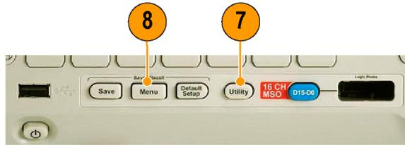
8. **Menü Save / Recall.** Drücken Sie diese Taste, um Setups, Signale und Bildschirmabbildungen in einem internen Speicher oder auf einem USB-Flash-Laufwerk zu speichern bzw. von dort abzurufen.
