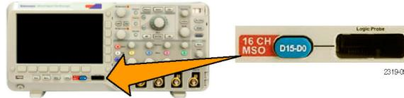
6. Drücken Sie die untere Rahmentaste **D15 - D0**, um auf das Menü „Ein“ oder „Aus“ für D15 - D0 zuzugreifen.
