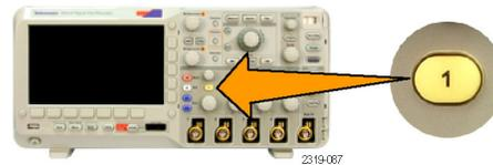
Schließen Sie den digitalen Tastkopf an, und wählen Sie anschließend den Eingangskanal aus. (Siehe Seite 63, *Einrichten digitaler Kanäle (nur Serie MSO2000)*.)
