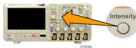
Dadurch wird die Anzeige für die Intensität auf dem Bildschirm angezeigt.
