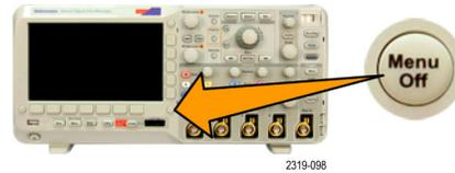
3. Lassen Sie die Taste **Menu Off** los, und lassen Sie anschließend die Taste **Autoset** los.
