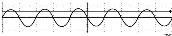
1. Mit Hilfe des Drehknopfs **Trigger-Pegel** können Sie den Triggerpegel einstellen, ohne dazu ein Menü aufrufen zu müssen.
