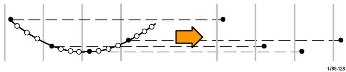
Der Glitch-Erfassungshintergrundmodus von FilterVu verwendet den jeweils höchsten und niedrigsten Abtastwert aus zwei aufeinanderfolgenden Erfassungsintervallen. Bei schnellen Einstellungen für die Zeit pro Skalenteil ist der Glitch-Erfassungshintergrundmodus nicht verfügbar. Dieser Modus wird bei anderen Oszilloskopen auch als Spitzenwertmodus bezeichnet.
