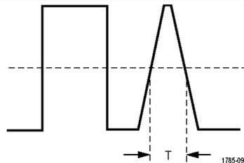
Trigger auf Impulse, die kürzer als, länger als, gleich oder ungleich einer angegebenen Zeit sind. Es kann auf positive oder negative Impulse getriggert werden. Impulsbreitentrigger werden primär für digitale Signale verwendet.
