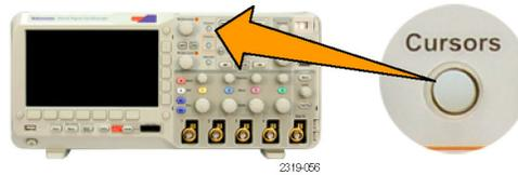
6. Drehen Sie die Mehrzweck-Drehknöpfe **a** und **b**, um die beiden horizontalen Cursor zu verschieben.
