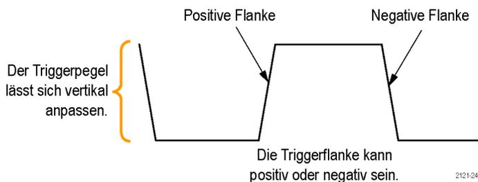
Das Oszilloskop stellt lange horizontale Leisten über dem Raster bereit, um den Triggerpegel vorübergehend anzuzeigen.
