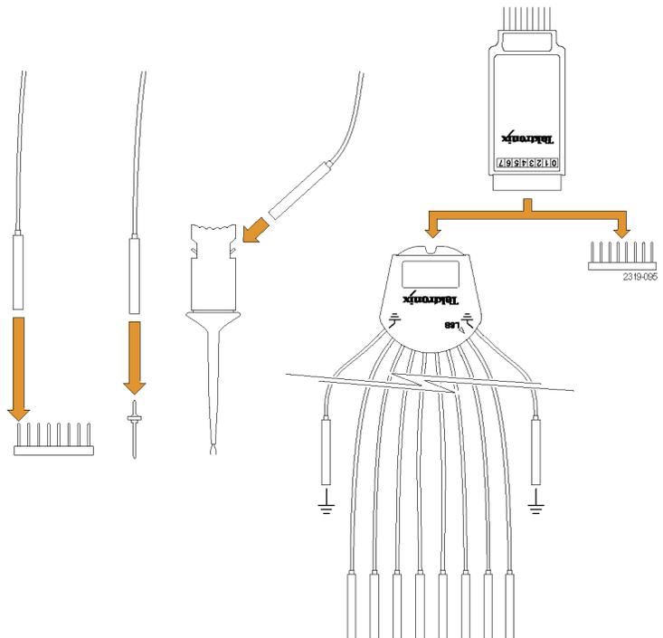
2. Verbinden Sie den oder die Erdungsleiter mit der Schaltkreiserdung.
