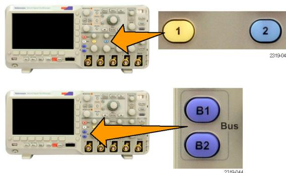
2. Drücken Sie eine Taste auf dem unteren Rahmen, um eine Bezeichnung zu erstellen, z. B. für Kanal 1 oder B1.
