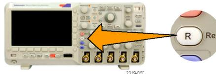
2. Drücken Sie die Taste **R1** oder **R2** auf dem unteren Rahmen, um das Referenzsignal aus der Anzeige zu entfernen.
