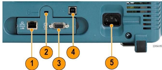
**HINWEIS.** Das Kabel, das die USB 2.0-Geräteschnittstelle und den Host-Computer verbindet, muss den USB 2.0-Spezifikationen für Hochgeschwindigkeitsbetrieb entsprechen, wenn es an einen Hochgeschwindigkeits-Host-Controller angeschlossen wird.
