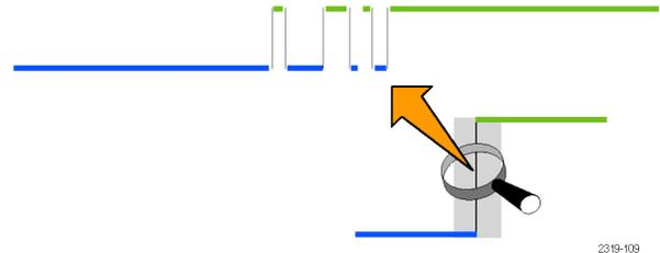
Nachdem Sie mit dem Zoom so stark vergrößert haben, dass pro Abtastung eine Säule von mehr als einem Pixel Breite angezeigt wird, wird die Unsicherheit der Flankenposition durch eine hellgraue Schattierung dargestellt.
