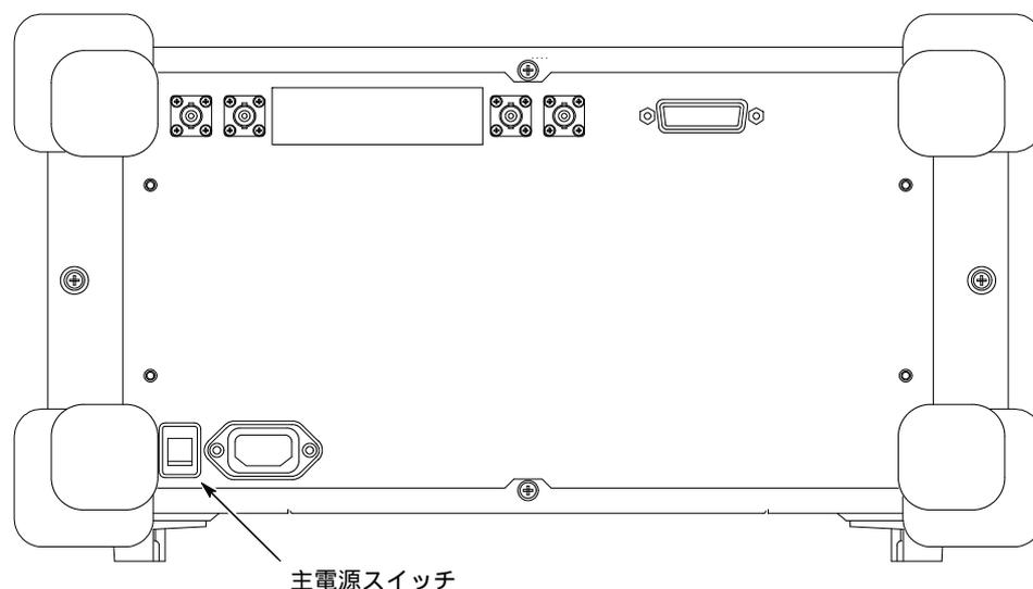
図 1-10 : 主電源スイッチ (後部パネル)
