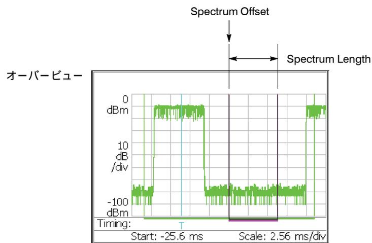
図 4-31 : オーバービューでの FFT 処理範囲設定
