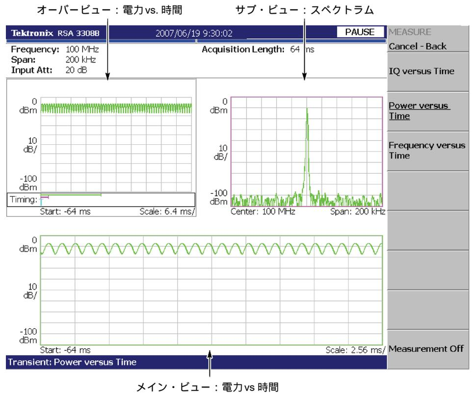
図 4-65 : 電力変動測定例
