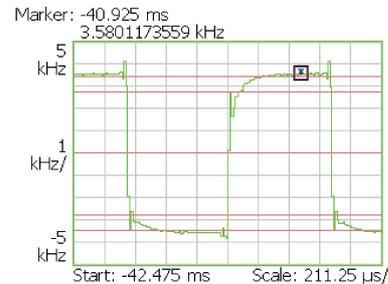
図 4-58 : RF エンベロープ / FSK パルス測定 (メイン・ビュー)
