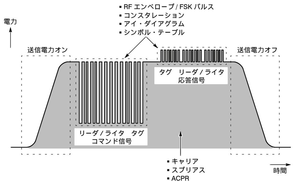
図 4-51 : RFID 波形と測定項目
