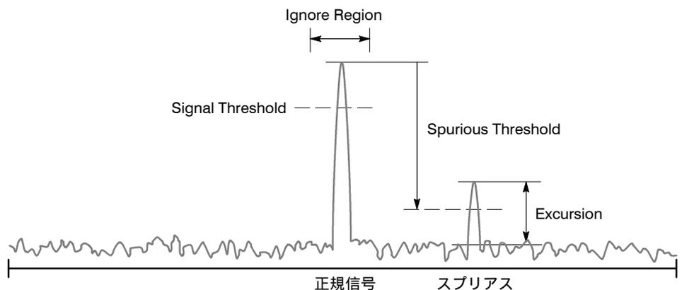
図 4-14 : スプリアス測定のセットアップ
