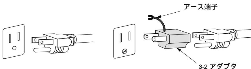
本機器外面の金属部分は、電源コードのグランド・ラインを通して電源の保護用接地端子に接続されます。感電を防ぐために、保護用接地端子の付いたコンセントにプラグを差し込んでください。
