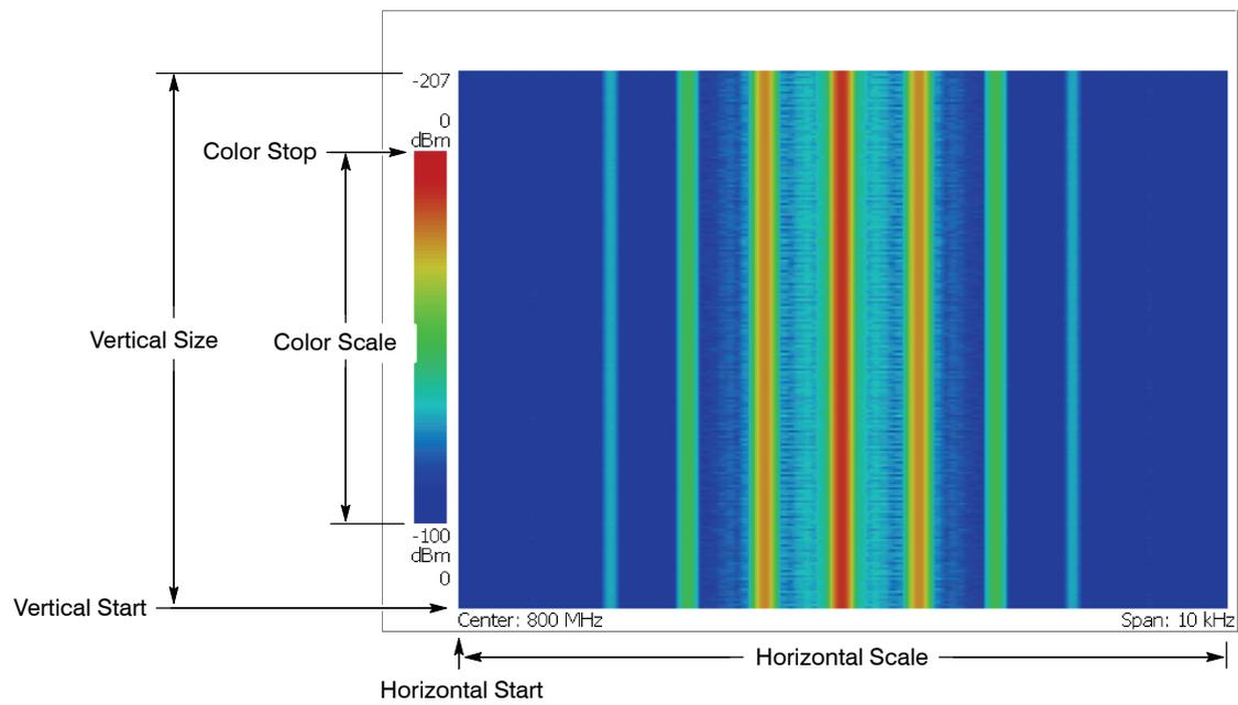
図 4-131 : スペクトログラム表示のスケールとフォーマットの設定
