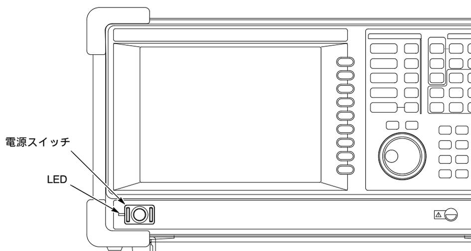
図 1-11 : 電源スイッチ (On/Standby スイッチ)
