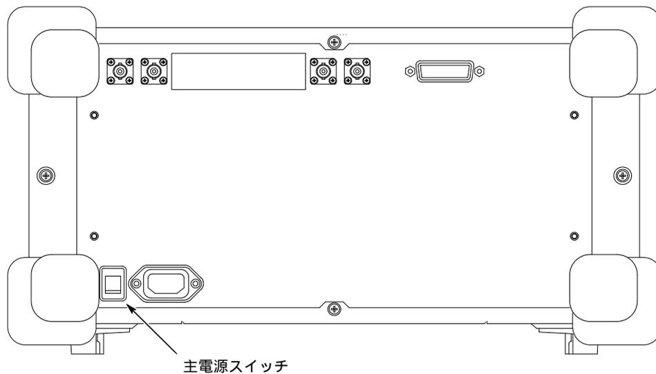
図 2-2 : 主電源スイッチ (後部パネル)
