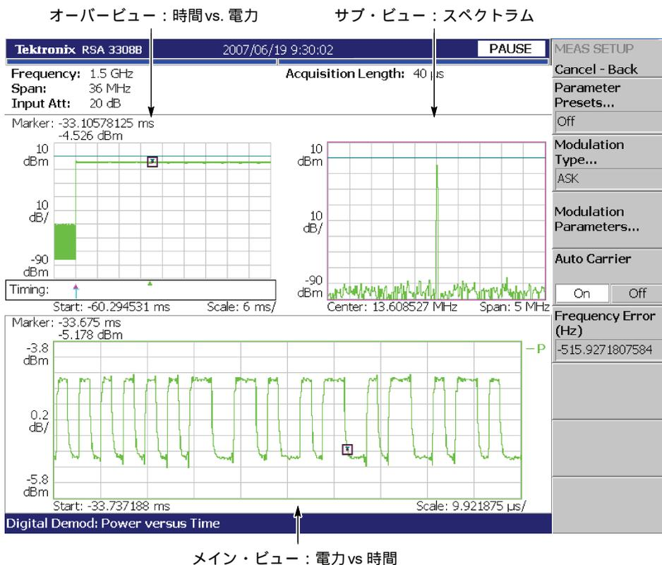
図 4-43 : 電力変動測定例
