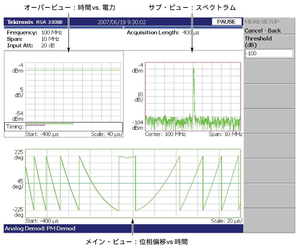
図 4-36 : PM 変調信号測定例
