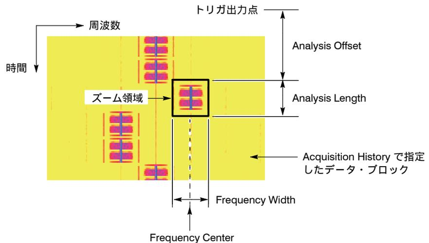
図 4-100 : ズーム・モードのデータ解析 / 解析パラメータ
