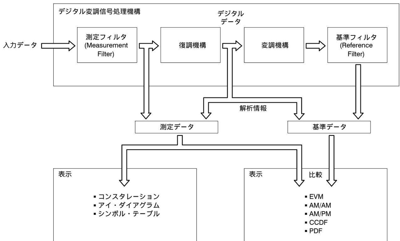
図 4-39 : デジタル変調信号処理の流れ
