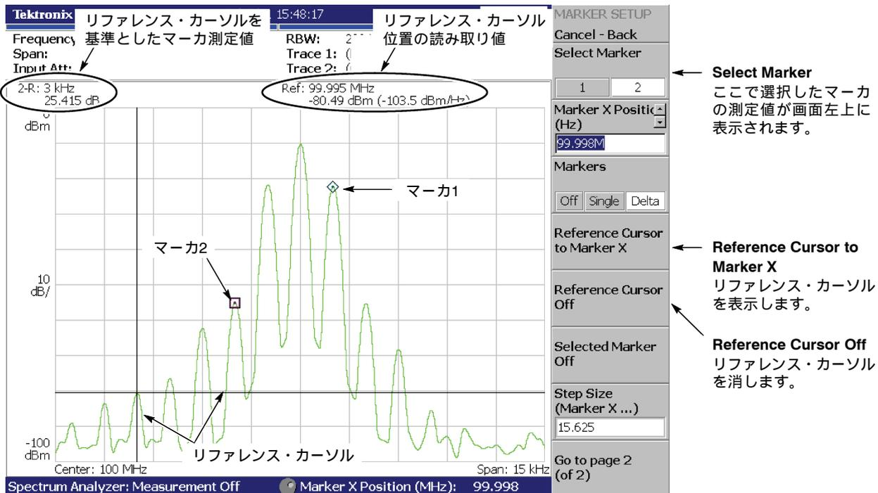
図 4-155 : リファレンス・カーソルを使用した測定
