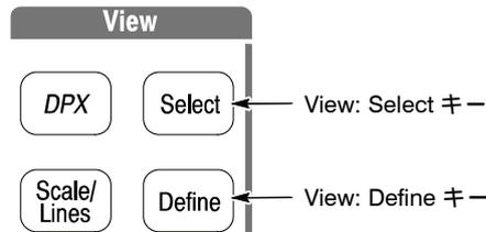
2. 前面パネルの View エリアにある Select キーを押して、1 ビュー表示にするビューを選択します。選択したビューは、白い枠で囲まれます。
