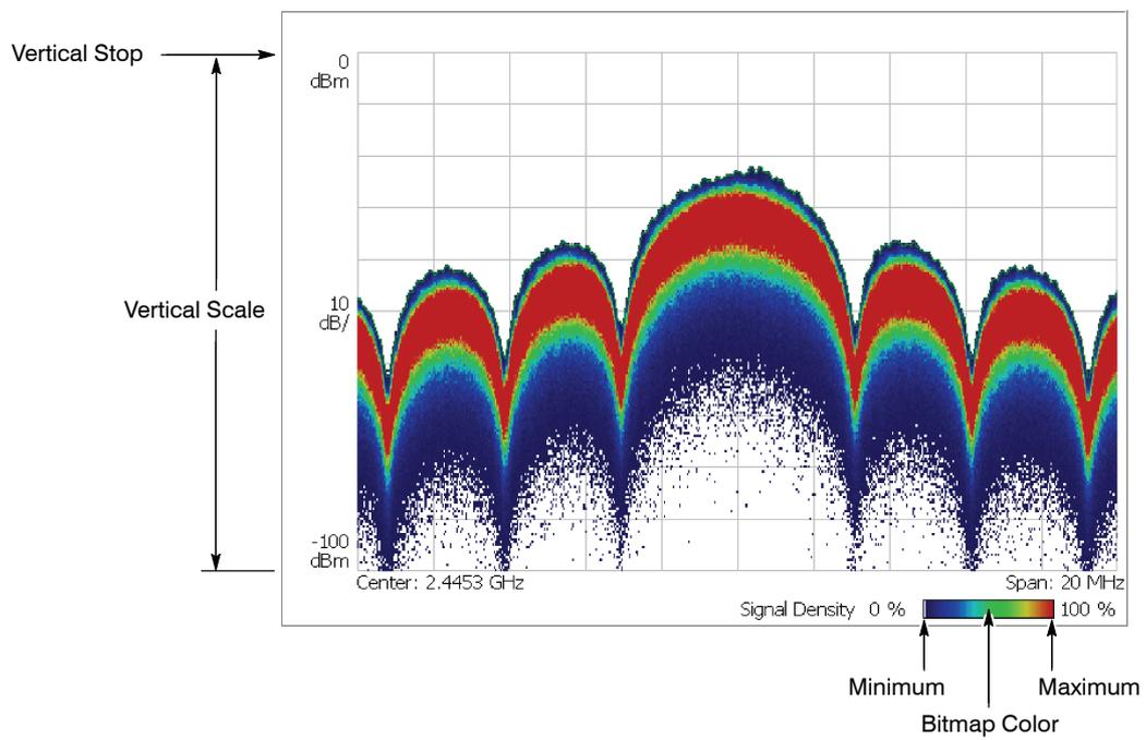
図 4-130 : DPX スペクトラム表示のスケール設定
