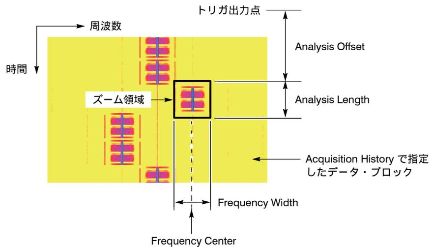
図 4-24 : Acquisition/Analysis メニューを使用したズーム領域設定
