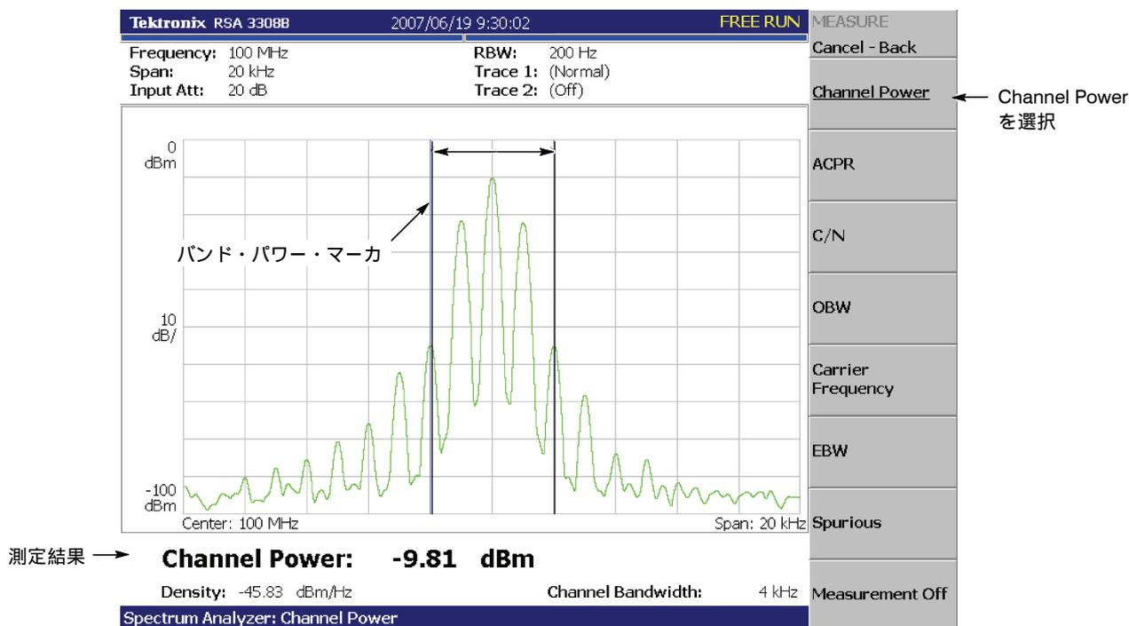
図 2-24 : チャンネル電力測定例
