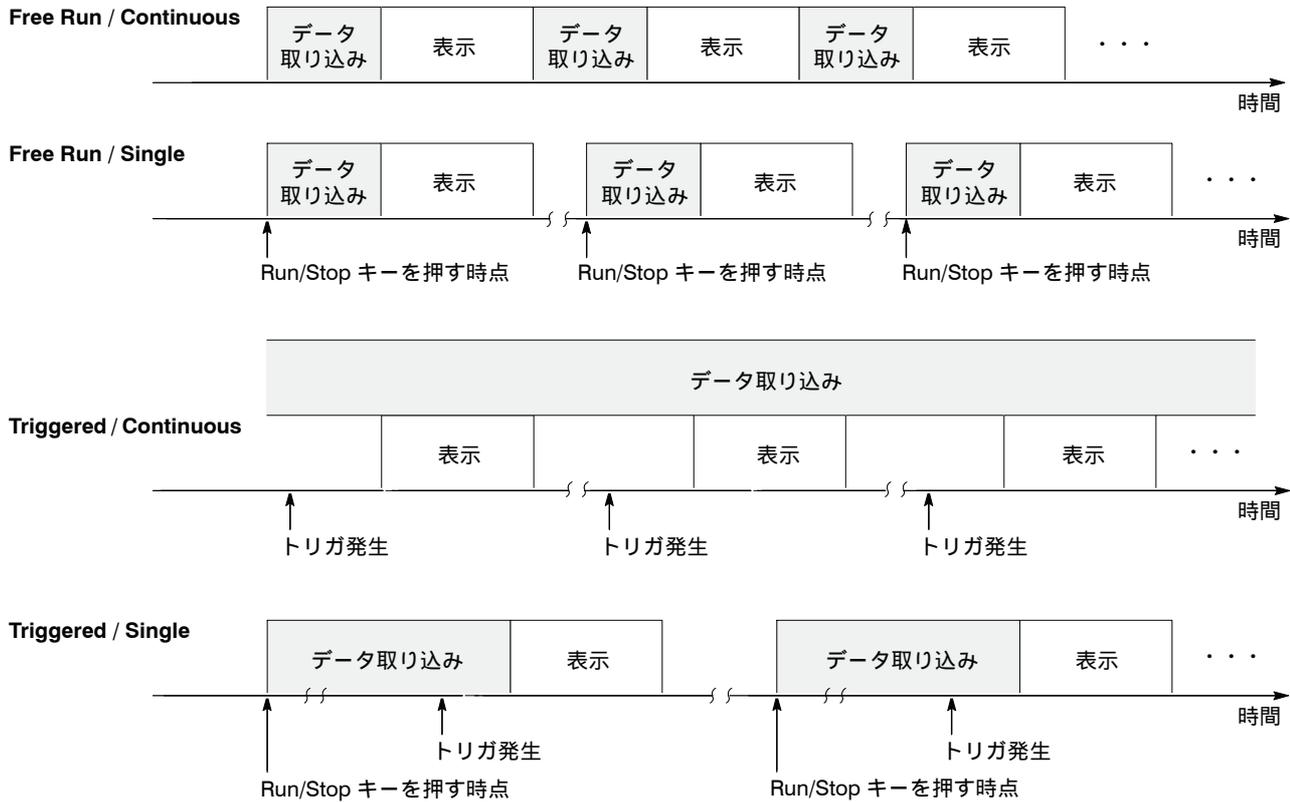
図 4-107：トリガおよびリピート・モードによるデータ取り込みと表示
