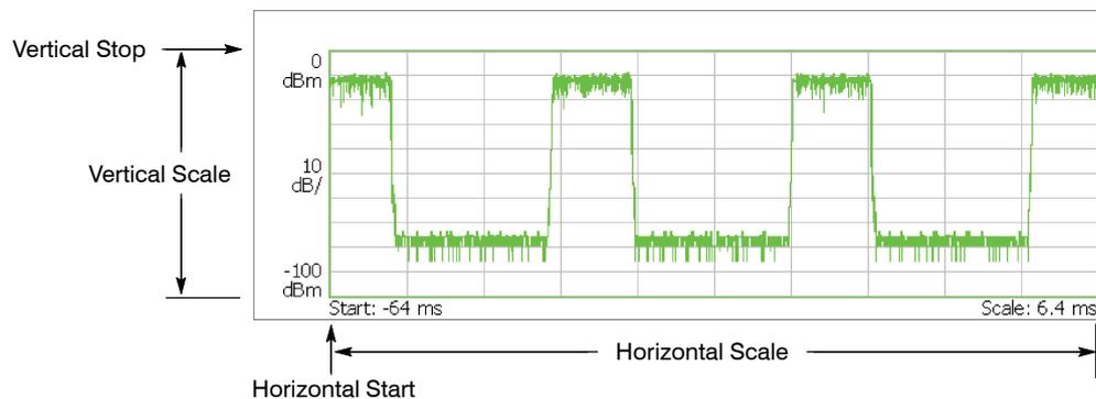
縦軸：AM 変調率、FM 周波数偏移、PM 位相偏移、または IQ 電圧（下図は AM 変調率の例）
