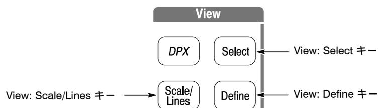
3. 前面パネルの View: **Define** キーを押し、**Show Views** サイド・キーを押し、**Single** を選択します。メイン・ビューだけが画面に拡大表示されます。
