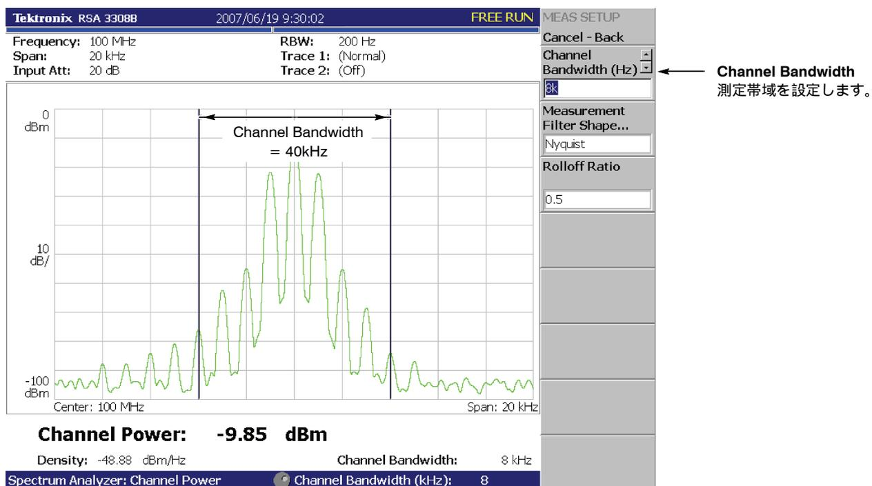
図 2-25 : チャンネル電力測定例 (測定帯域 8kHz)
