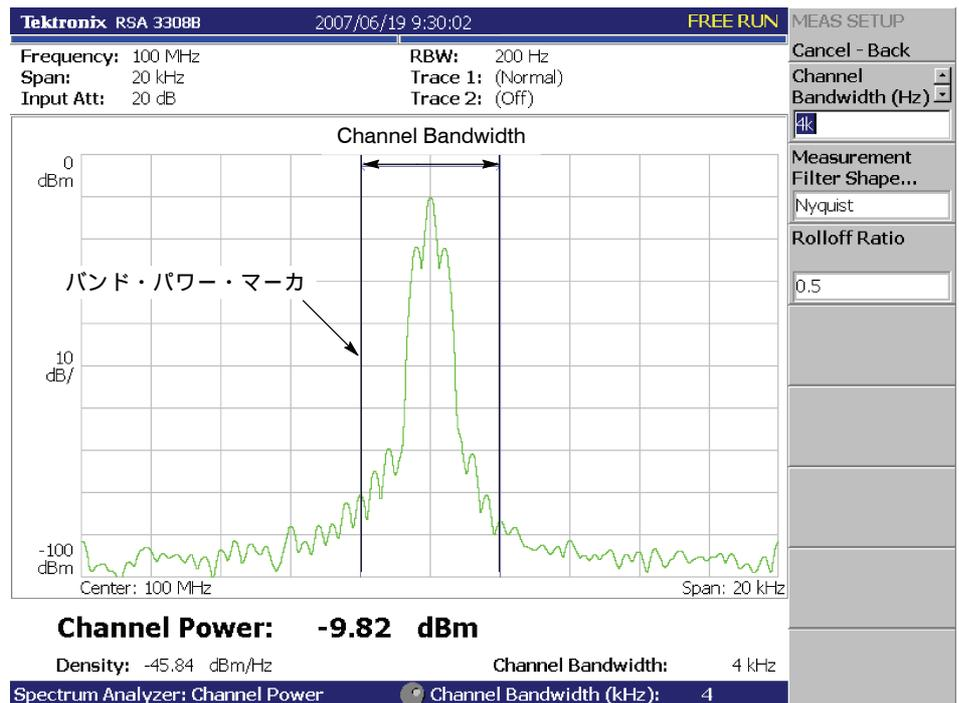
図 4-4 : チャンネル電力測定例
