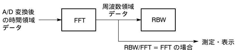
図 4-119：RBW/FFT = FFT のときの処理の流れ
