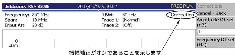
振幅補正がオンであることを示します。
