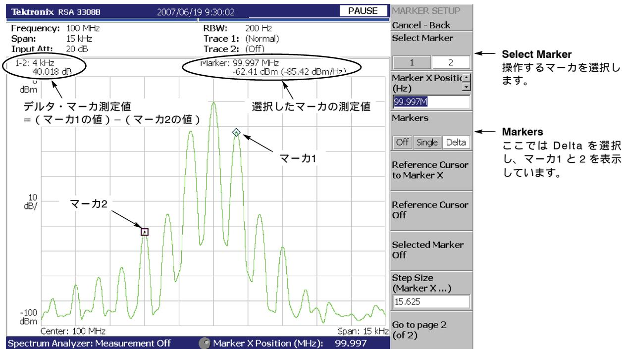
図 4-154 : デルタ・マーカを使用した測定
