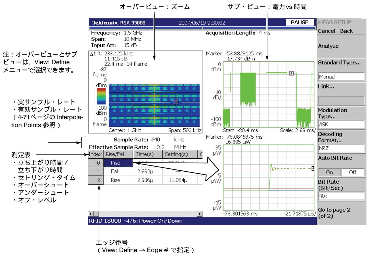
図 4-57 : 送信電力オン/ダウン測定
