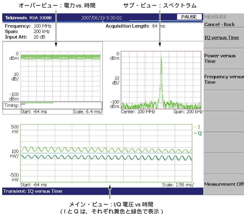
図 4-64 : IQ レベル変動測定例
