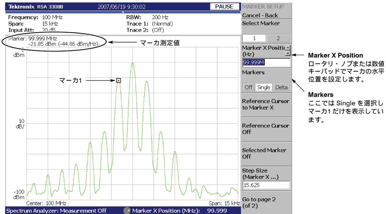
図 4-153 : メイン・マーカを使用した測定
