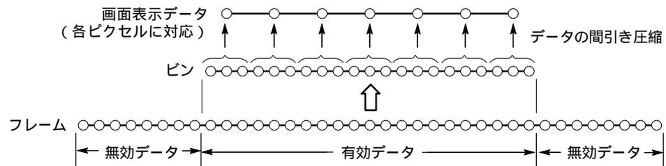
図 4-127：フレーム、ビン、ピクセルの関係
