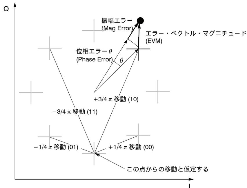
図 4-137 :  $1/4 \pi$  QPSK のコンスタレーション表示例と誤差ベクトル
