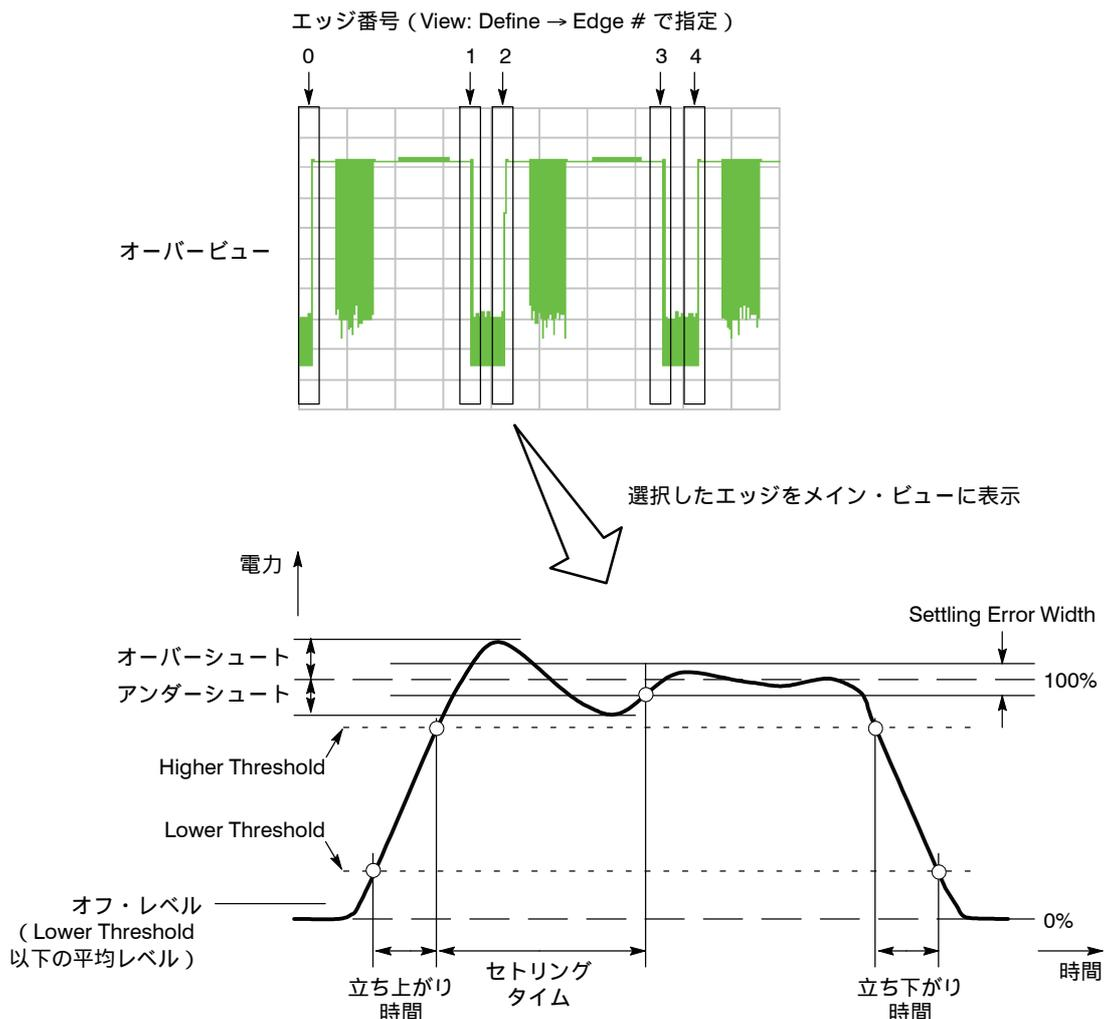
図 4-56 : 送信電力オン / ダウン測定パラメータ
