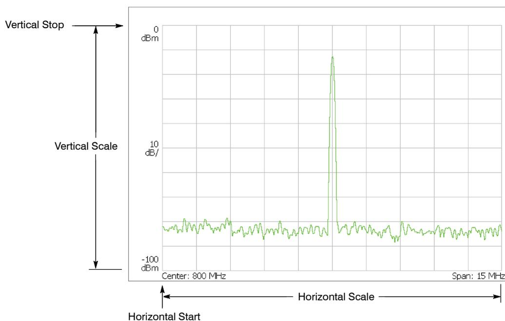
図 4-129 : スペクトラム表示のスケール設定
