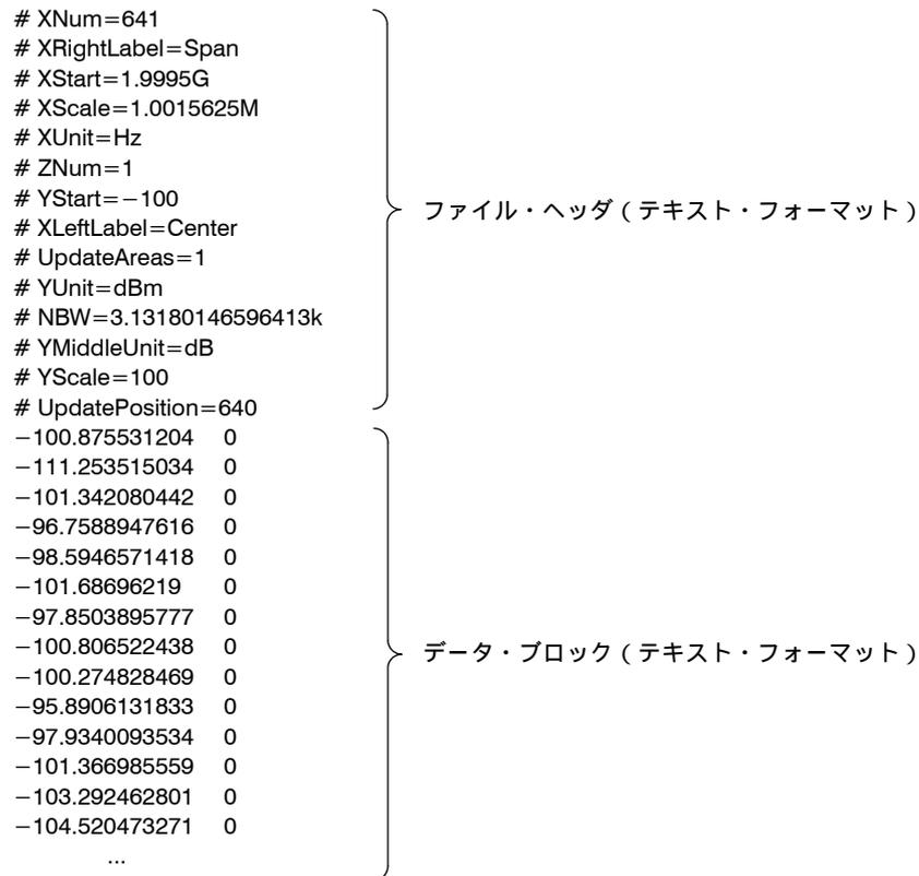
図 4-178 : トレース・ファイル (.TRC) の構造
