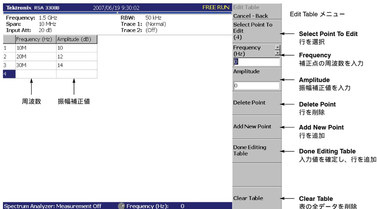
図 4-94 : 振幅補正データの入力
