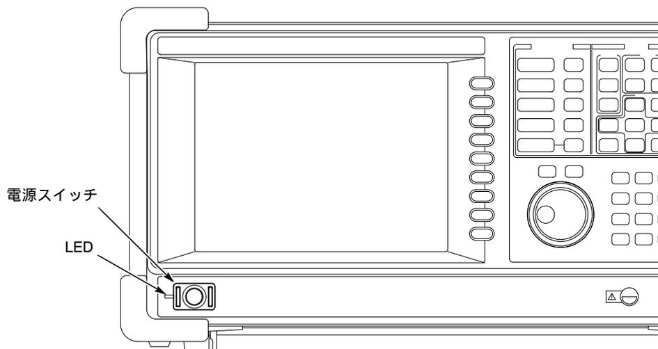
図 2-3 : 電源スイッチ (ON/STANDBY スイッチ)
