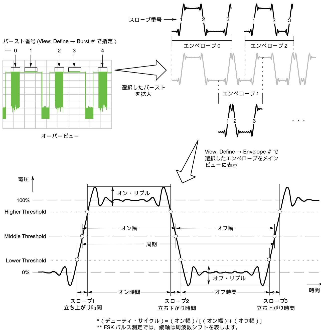
図 4-59 : RF エンベロープ / FSK パルス測定パラメータ
