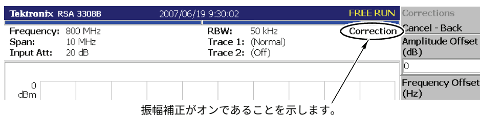
図 4-107：振幅補正のセットアップ表示
