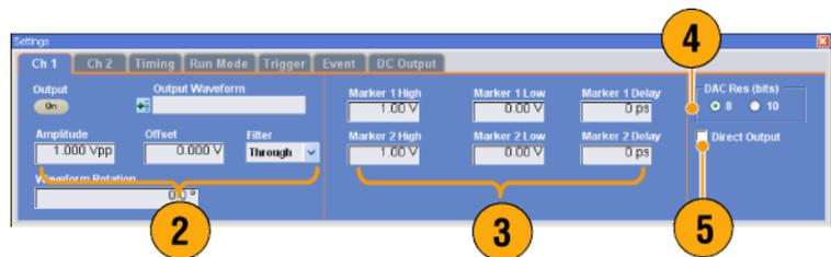
4. (AWG7000 系列) 選取 10 bits (位元) DAC Resolution (DAC 解析) 時，會停用 Marker Outputs(標記輸出)。
