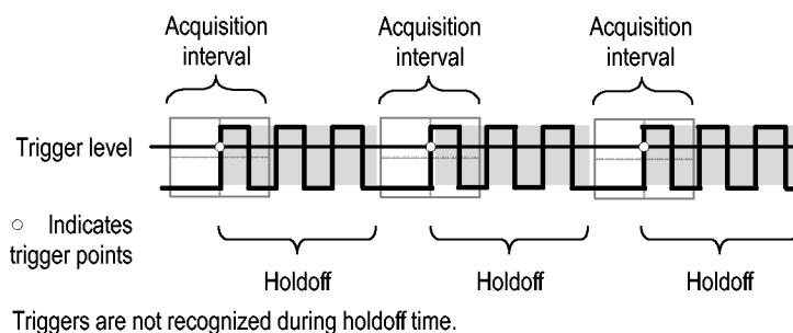
トリガ・ホールドオフを使用するには、Horiz ▶ Set Trigger Holdoff オプション・ボタンを押し、汎用ノブを使用してホールドオフを調節します。トリガ・ホールドオフの分解能は水平軸のスケール設定によって変わります。
