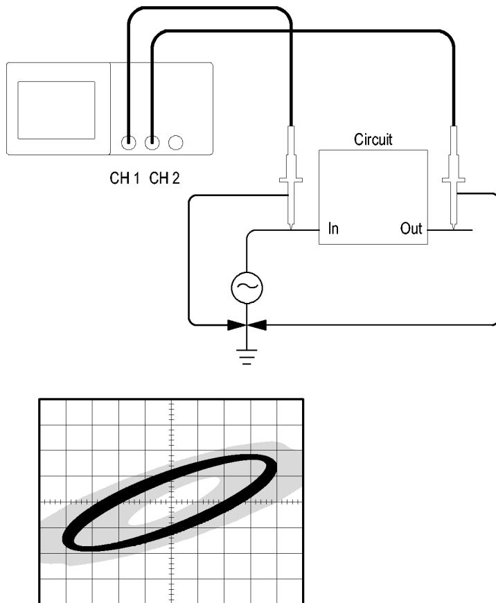
回路の入力と出力を XY 表示で見るには、次の手順を実行します。
