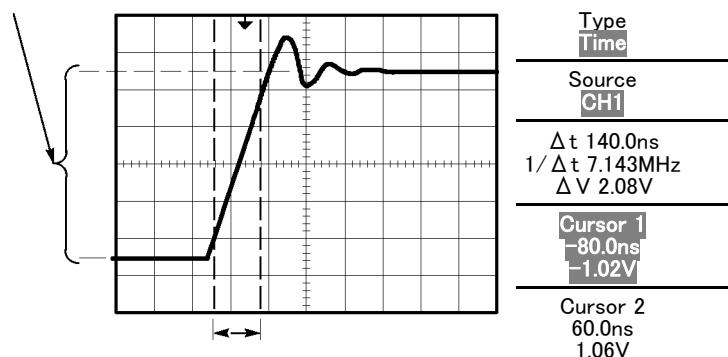
**注:** Measure Menu(波形測定メニュー)の自動測定として立上り時間測定を行えます。(94 ページ「測定の実行」参照)。
