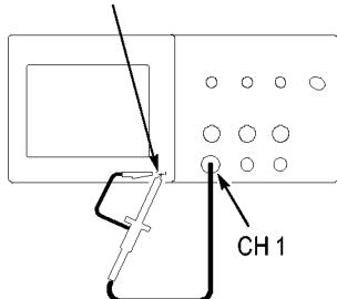
2. TPP0101 または TP0201 型プローブをオシロスコープのチャンネル 1 に接続します。接続するには、プローブのコネクタのスロットと CH 1 BNC のキーを揃えて押しこみ、右に回して固定します。
