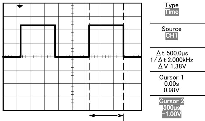
**注:** Measure Menu(波形測定メニュー)の自動測定として正のパルス幅測定を実行できます。(94 ページ「測定の実行」参照)。
