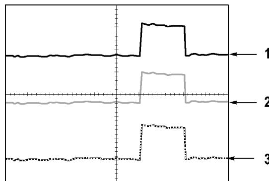
1. 実線の波形は、チャンネル(ライブ)波形の表示を示します。アクイジションが停止されたとき、表示確度が不確定になるコントロールの変更が行われなければ、波形の表示は実線のままになります。
