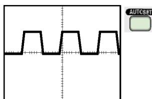
3. AUTOSET(オートセット)ボタンを押します。数秒以内に、約 5V p-p、周波数 1 KHz の方形波がディスプレイに表示されます。
