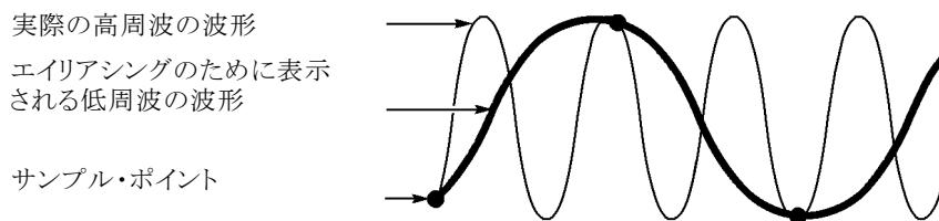
このオシロスコープは信号を正確に表現しますが、プローブの帯域幅、オシロスコープの帯域幅、およびサンプル・レートによる制限を受けます。エイリアシングを防ぐには、信号の最大周波数成分の 2 倍以上の速度で信号をサンプリングする必要があります。
