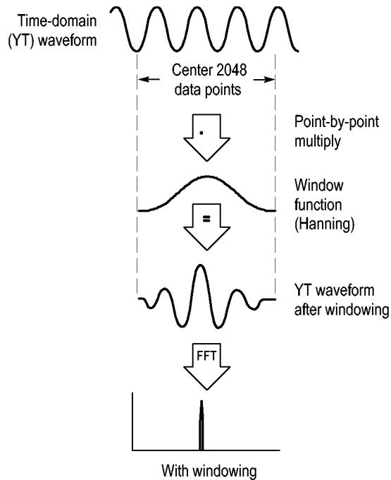
FFT 演算機能には、3 種類の FFT ウィンドウ・オプションが用意されています。各種類のウィンドウは、周波数分解能と振幅確度の点で相反する性質を持っています。測定する項目やソース信号の特性によって、どのウィンドウを使用するかを決定します。
