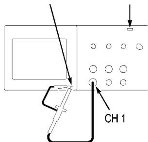
1. 1 ▶ Probe (プローブ) ▶ Voltage (電圧) ▶ Attenuation (減衰) オプションを押し、10X を選択します。TPP0101 および TPP0201 型 プローブをオシロスコープのチャンネル 1 に接続します。プローブ・フックチップを使用する場合は、チップをプローブにしっかりと差し込んで取り付け、適切に接続されていることを確認してください。
