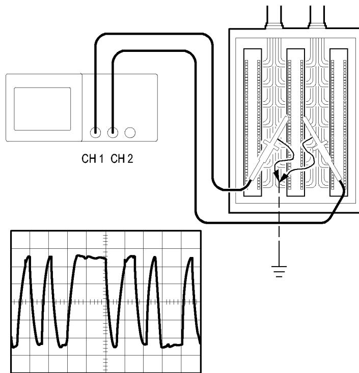
**注:** 最初に両方のプローブを補正するようにしてください。プローブ補正が異なっていると、差動信号にエラーが現れます。
