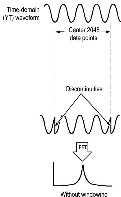
YT 波形にウィンドウを適用すると、振幅が変化して開始と終了の値が近づき、不連続の発生を抑えることができます。
