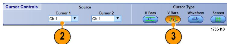
4. Um Messungen zwischen zwei Signalen vorzunehmen, wählen Sie **Waveform** (Signal) und wählen dann die Signal-Quelle für jeden Cursor aus.
