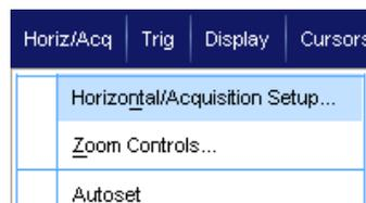
Im Modus Automatic (Automatisch) können Sie die Skala und die Abtastrate festlegen. Die Aufzeichnungslänge ist eine abhängige Variable. Wenn beim Ändern der Skala die Aufzeichnungslänge die Obergrenze für die Aufzeichnungslänge überschreiten würde, wird die Abtastrate auf die nächste verfügbare Einstellung gesenkt.
