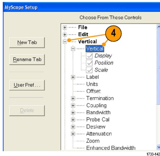
5. Deaktivieren Sie die Kontrollkästchen, um diejenigen Komponenten zu entfernen, die nicht zu dem Steuerelement gehören sollen.
