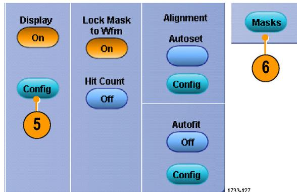
7. Klicken Sie auf **Lock Mask to Wfm On** (Maske auf Wfm verriegeln AN), um Änderungen an den horizontalen oder vertikalen Einstellungen der Maske zu überwachen.
