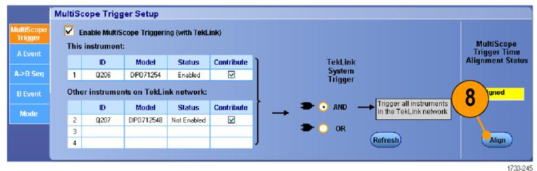
9. Wenn das Gerät im TekLink-Netzwerk prüfen soll, welche Instrumente an das TekLink-Netzwerk angeschlossen sind, drücken Sie die Taste **Refresh** (Aktualisieren).
