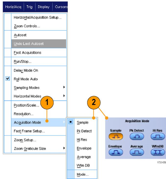
3. Klicken Sie zum Einstellen der Erfassungsmodi „Mittelwert“ oder „Hüllkurve“ auf das Steuerelement **# of Wfms** (Anzahl der Signale). Stellen Sie dann mit dem Mehrfunktions-Drehknopf die Anzahl der Signale ein. Um den Modus WfmDB einzustellen, klicken Sie auf das Steuerelement **Samples** (Abtastwerte) und legen dann die Anzahl der Abtastwerte mit dem Mehrfunktions-Drehknopf fest.
