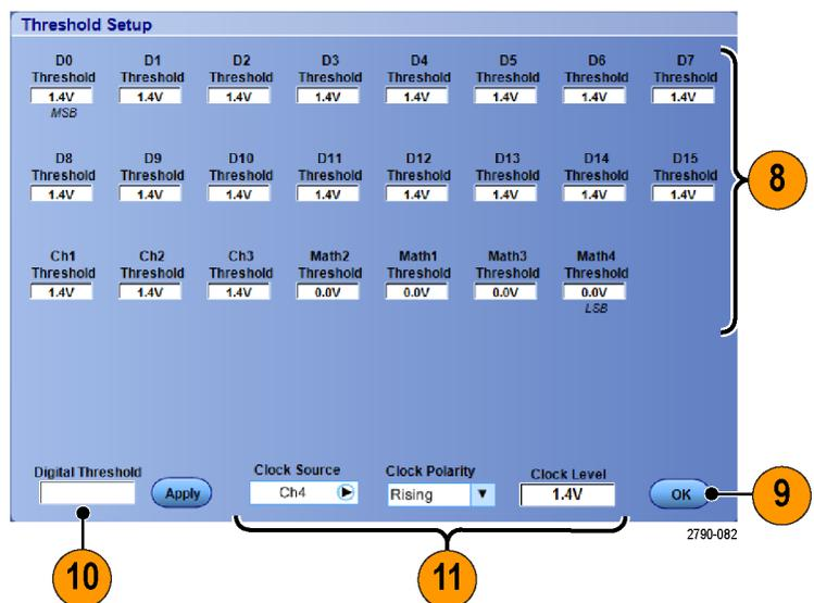
11. Um die Taktquelle und die Polarität bei Geräten der Serie MSO70000/C einzustellen, doppelklicken Sie auf das Element, und wählen Sie aus der angezeigten Liste aus. Um den Taktpegel einzustellen, doppelklicken Sie auf „Clock Level“ (Taktpegel), und geben Sie über das Tastenfeld oder den Mehrfunktions-Drehknopf den Pegel ein.
