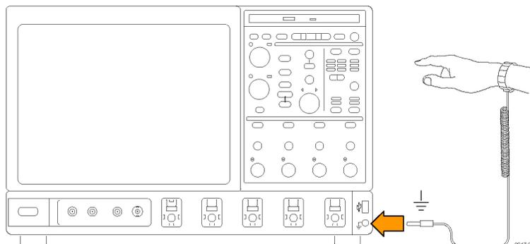
2. Ein lose auf einer Arbeitsplatte liegendes Kabel kann eine hohe statische Ladung aufbauen. Leiten Sie die statische Ladung aller Kabel vor dem Anschluss an das zu testende Instrument oder Gerät ab, indem Sie den Innenleiter des Kabels kurz erden. Sie können auch vor Anschluss am Instrument an einem Ende des Kabels einen 50 Ω-Abschluss anklebmen.
