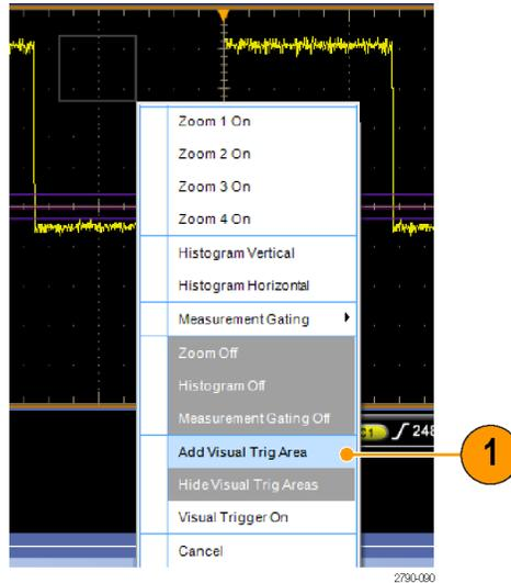
2. Klicken Sie auf den Bereich, um die Ziehpunkte dafür zu aktivieren. Klicken Sie auf den Bereich und ziehen Sie ihn, um ihn neu zu positionieren. Klicken Sie auf einen der Ziehpunkte des Bereichs und ziehen Sie diesen, um die vertikale oder horizontale Größe des Bereichs oder beide zu ändern.
