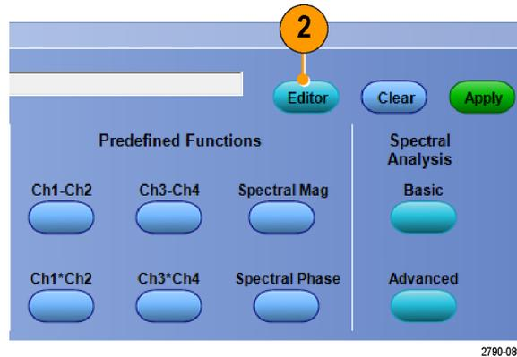
3. Erstellen Sie den erweiterten Ausdruck für das mathematische Signal mithilfe von Quellen, Operatoren, Konstanten, Messungen, Variablen und Funktionen.
