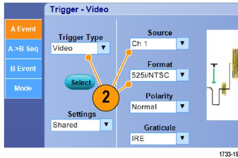
3. Wählen Sie **Trigger On > Field** (Trigger Ein > Halbbild) aus.
