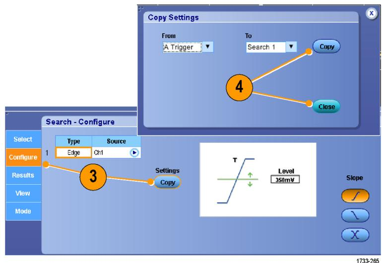
5. Wenn Sie die aktuellen Sucheinstellungen ändern möchten, passen Sie die angezeigten Bedienelemente an. Die angezeigten Bedienelemente variieren je nach der ausgewählten Suche.
