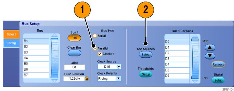
3. Klicken Sie für jeden Kanal, den Sie dem Bus zuordnen wollen, auf die Schaltfläche. Die Reihenfolge des parallelen Busses wird durch die Reihenfolge bestimmt, in der Sie die Kanäle auswählen. Digitale Kanäle sind nur bei Geräten der Serie MSO als Quellen verfügbar.
