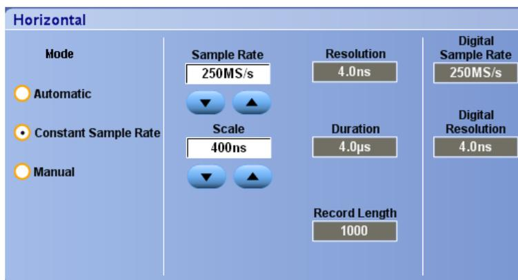
Im Modus Manual (Manuell) können Sie die Abtastrate und die Aufzeichnungslänge festlegen. Die horizontale Skala ist eine abhängige Variable, die aus Abtastrate und Aufzeichnungslänge berechnet wird.
