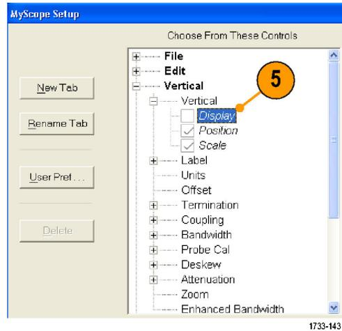
6. Klicken und ziehen Sie das Steuerelement in das MyScope-Steuersfenster. Wenn Sie die Maustaste loslassen, wird das Steuerelement an nächstgelegenen durch das Raster definierten Platz abgelegt. Sie können die Lage des Steuerelements im MyScope-Steuersfenster durch Klicken und Ziehen verändern.
