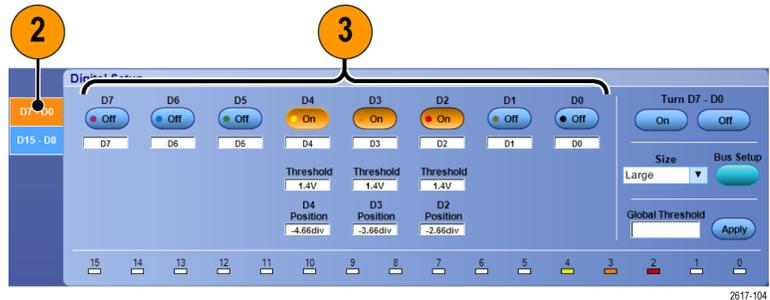
4. Klicken Sie auf **Threshold** (Schwellenwert) oder **Position**, und stellen Sie sie mithilfe der Tastatur oder der Mehrfunktions-Drehknöpfe ein. Sie können die Schwellenwerte aller 16 Kanäle durch die Eingabe eines globalen Schwellenwerts und anschließendes Klicken auf **Apply** (Übernehmen) einstellen.
