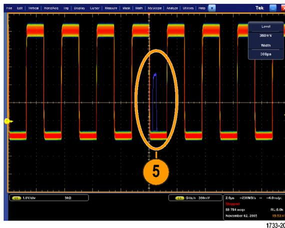
6. Um auf dem in Schritt 5 gefundenen Glitch zu triggern, wählen Sie **Glitch Setup...** (Glitch-Einstellung...) aus.
