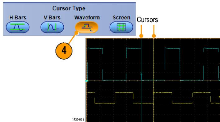
5. Wählen Sie **Cursors > Cursor Position...** (Cursor > Cursorposition...) aus, und regeln Sie anschließend mit den Mehrfunktions-Drehknöpfen die Cursorposition ein.
