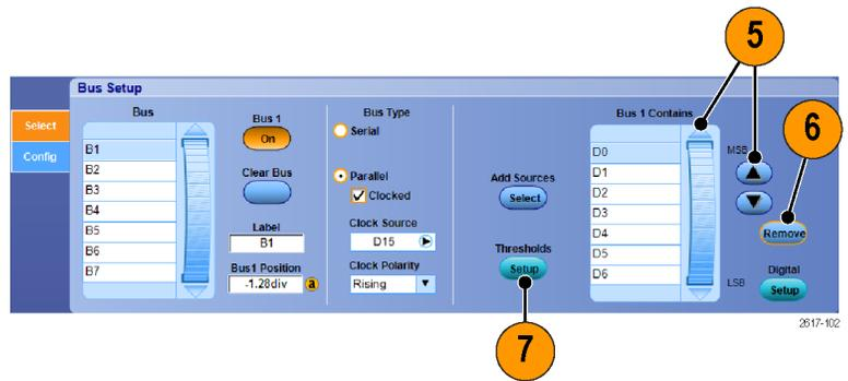
8. Für jeden Schwellenwert, den Sie einstellen wollen, doppelklicken Sie beim entsprechenden Kanal in das Feld **Threshold** (Schwellenwert), und geben Sie mithilfe des Tastenfeldes oder der Mehrfunktions-Drehknöpfe den Schwellenwert ein.
