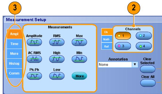
4. Um alle Messungen zu entfernen, wählen Sie **Clear All** (Alle entfernen).
