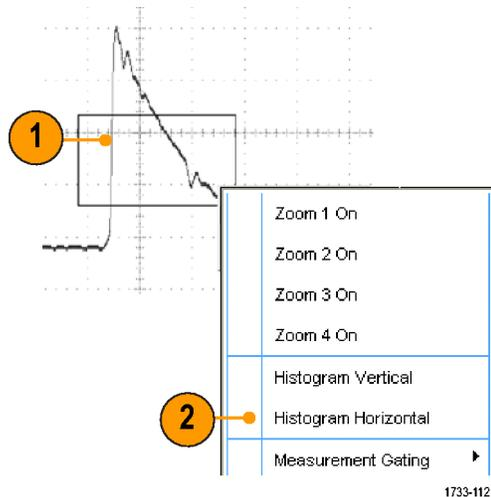
3. Zeigen Sie das Histogramm oben (bei horizontalen Histogrammen) oder am linken Rand (bei vertikalen Histogrammen) des Rasters an.
