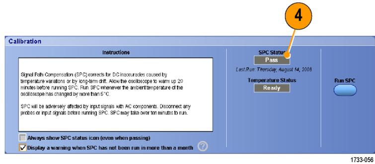
5. Wenn die SPC-Anzeige rot leuchtet, führen Sie eine Signalpfadkompensation durch.
