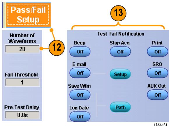
13. Pass/Fail Test Notifications を選択します。
