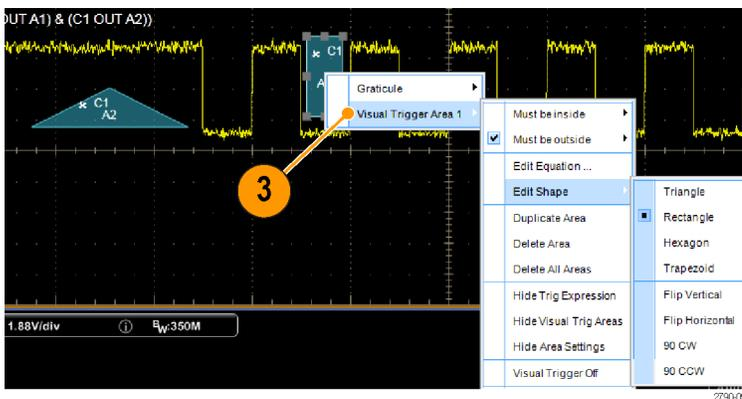
4. Trig メニューから Visual Trigger Setup を選択し、Visual Trigger equation をダブルクリックします。
