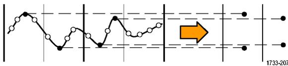
**Hi Res** モードでは、各アキュイジション間隔にあるすべてのサンプルの平均が計算されます。ハイレゾは、高分解能で低帯域幅の波形を表示します。
