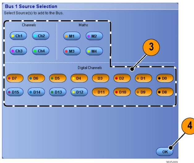
5. バス内のチャンネルを移動するには、移動するチャンネルまでスクロールして選択し、上矢印または下矢印ボタンをクリックします。
