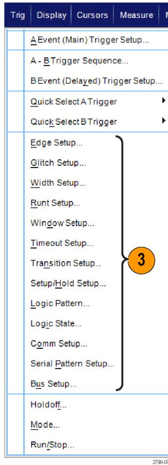
4. トリガ・タイプに表示されるコントロールを使用して、トリガの設定を完了します。トリガを設定するためのコントロールは、トリガ・タイプ、機器のモデル、またオプションにより異なります。
