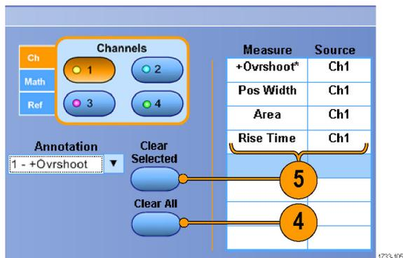
Measure メニューで波形の測定方法を直接選択することもできます。(120 ページ「自動測定一覧」参照)。
