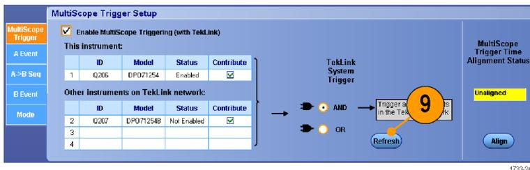
10. MultiScope トリガが有効になっている場合は、トリガ・リードアウトに表示されます。
