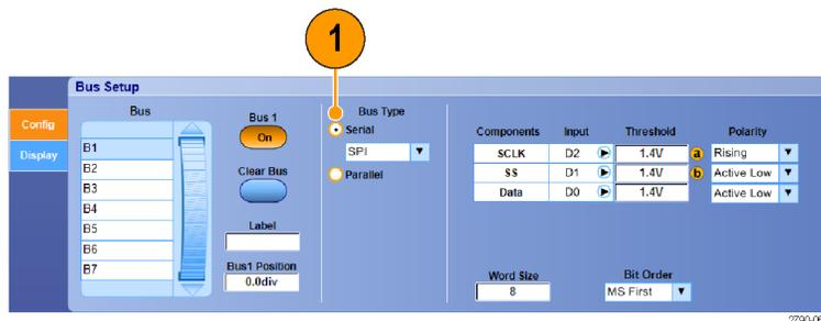
2. 表示されたバスのコンポーネントに対する入力を選択するには、コンポーネントの **Input** フィールドをクリックし、表示されたリストから選択します。
