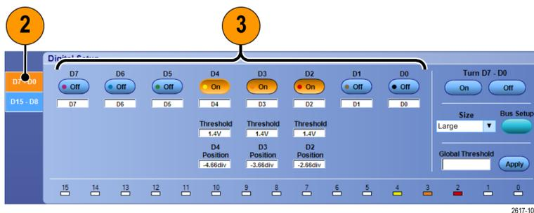
4. **Threshold** または **Position** をクリックし、キーボードまたは汎用ノブで調節します。または、全 16 チャンネル共通の **Global Threshold** 値を入力し、**Apply** をクリックします。
