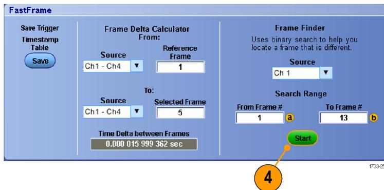
フレーム・ファインダは異なるフレームを探し出して表示します。
