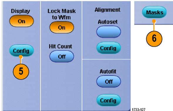
7. **Lock Mask to Wfm** をクリックして **On** にし、水平軸または垂直軸の設定の変更に合わせてマスクが変更されるようにします。
