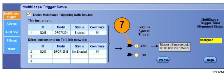
8. MultiScope トリガのアライメントを行うには、Align ボタンを押します。
