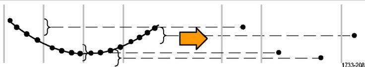
**Envelope** モードでは、多くのアキュイジションから最大および最小のレコード・ポイントが特定されます。エンベロープ・モードでは、各アキュイジションにピーク・ディテクトを使用します。
