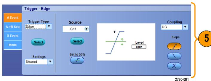
6. Mode タブで、Trigger Mode の **Normal** および Holdoff の **Auto** 選択します。
