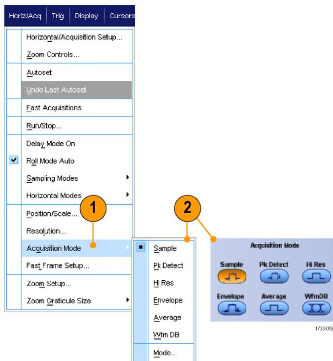
3. アベレージ・アキュイジション・モードまたはエンベロープ・アキュイジション・モードの場合は、**# of Wfms** コントロールをクリックしてから、汎用ノブを使用して波形の数を設定します。波形データベース・モードでは、**Samples** コントロールをクリックしてから、汎用ノブを使用してサンプルの数を設定します。
