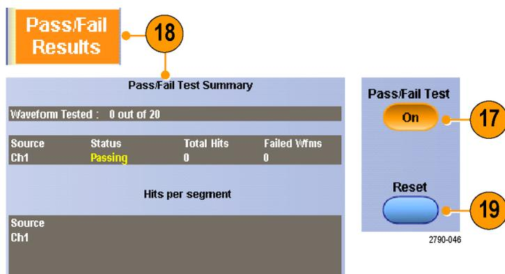
18. Pass/Fail Test をクリックし、On にすると、マスク・テストが開始されます。
