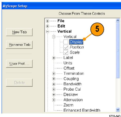
6. コントロールをクリックし、MyScope コントロール・ウィンドウまでドラッグします。マウス・ボタンを離すと、最も近いグリッド位置にコントロールが配置されます。コントロールをクリックしてドラッグすると、MyScope コントロール・ウィンドウ内のコントロールの配置を変更できます。
