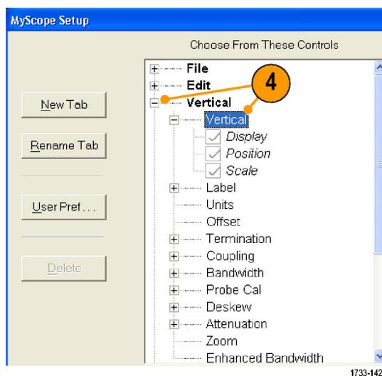
5. チェック・ボックスをオフにして、コントロールに表示しないコンポーネントを削除します。
