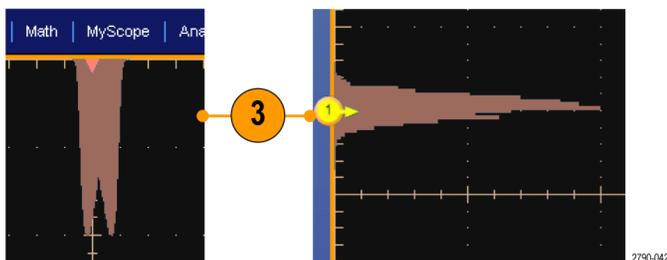
4. ヒストグラムのスケール、またはヒストグラム・ボックスのサイズおよび位置を調整するには、**Measure** > **Waveform Histograms** を選択して、Histogram Setup コントロール・ウィンドウを使用します。
