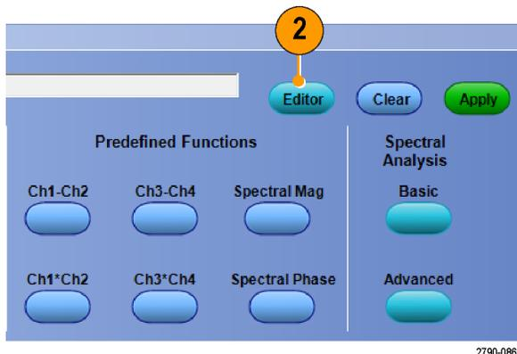
3. ソース、演算子、定数、測定、変数、および関数を使用して高度な演算波形式を作成します。
