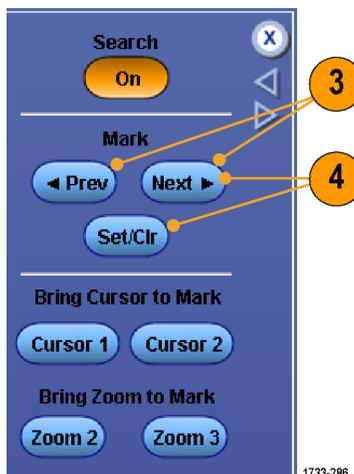
5. 検索マーク間を移動して波形を調べます。Next (→) または Prev (←) の矢印ボタンを使用すると、他のコントロールを調整せずに、マークされた場所の間を移動できます。
