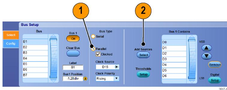
3. バスに含める各チャンネルのボタンをクリックします。パラレル・バスの順序はチャンネルを選択した順で決まります。デジタル・チャンネルはソースとして MSO70000 シリーズの機器でのみ使用できます。
