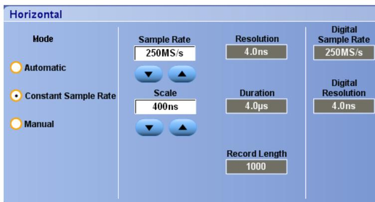
Manual モードでは、サンプル・レートとレコード長を設定できます。水平スケールは従属変数で、サンプル・レートとレコード長から計算されます。
