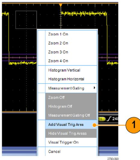
2. 領域をクリックすると、そのハンドルが有効になります。領域をクリックして、希望の位置にドラッグすることができます。枠のハンドルをクリック、ドラッグすると、垂直方向および水平方向に領域の大きさを調整できます。
