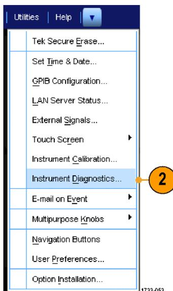
3. Run をクリックします。診断コントロール・ウィンドウにテスト結果が表示されます。
