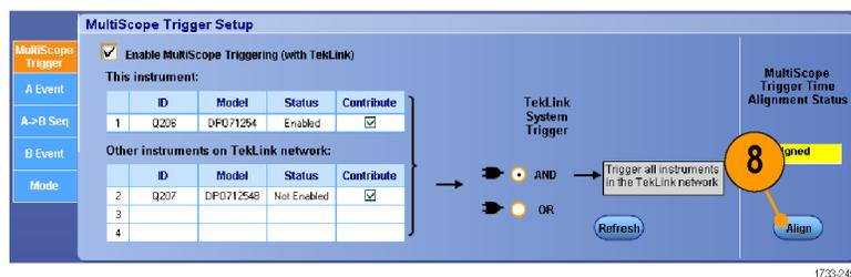
9. TekLink ネットワークをスキャンして、TekLink ネットワークに接続されている機器を確認するには、**Refresh** ボタンを押します。
