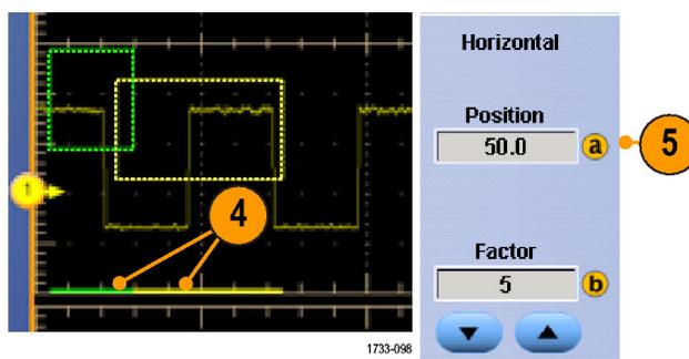
6. ズームした領域を垂直方向に調整するには、**Vertical > Zoom Setup...** を選択して、垂直フィールドをクリックし、汎用ノブを使用して Vertical Position と Factor を調整します。
