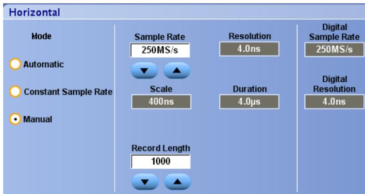
ここで示すように、3つのモードはすべて、サンプル・レート、スケール、およびレコード長と連動しています。水平ラインは、最大リアルタイム・サンプル・レートです。階段状の各ラインは、スケールを増やすと、サンプル・レートは、最大レコード長または設定したレコード長制限値に達したときに小さくなっていかなければならないことを示しています。Manual モードは、最大レコード長を使用します。
