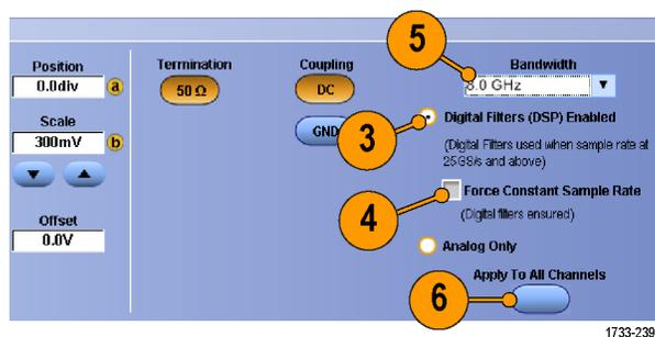
注： まだ設定されていない場合に Constant Sample Rate を選択すると、一定のサンプル・レートが確保されるよう水平モードが設定されます。このサンプル・レートは DSP が有効になるように設定され、さらに、DSP 帯域幅が選択されます。
