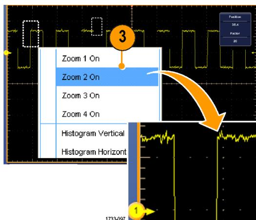
4. ズームしたエリアを水平方向に調整するには、Zoom ボックスの下にある水平マーカをクリックし、ズームしたエリアを選択します。
