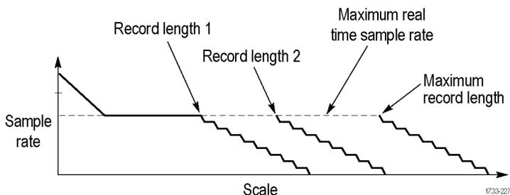
Automatic モードと Constant Sample Rate モードはまったく同じです。ただし、Constant Sample Rate モードの場合、サンプル・レートは、帯域幅拡張フィルタが確実に使用されるレートに保たれています。
