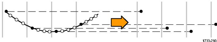
**Peak Detect** モードでは、連続した2つのアキュイジション間隔に含まれるすべてのサンプルの最大および最小のサンプルが使用されます。このモードは、補間のないリアルタイムのサンプリングでのみ使用でき、高周波数のグリッチを捕捉するのに便利です。
