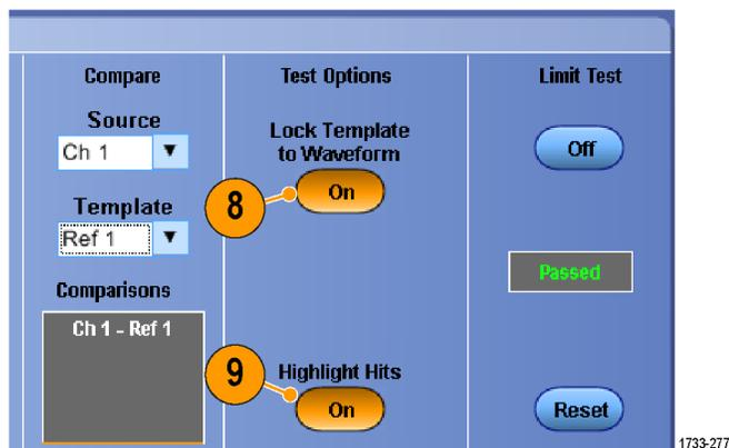
10. Limit Test を **On** に切り替えると、テストが開始されます。
