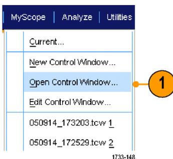
2. 使用するコントロール・ウィンドウを選択し、**Open** をクリックします。
