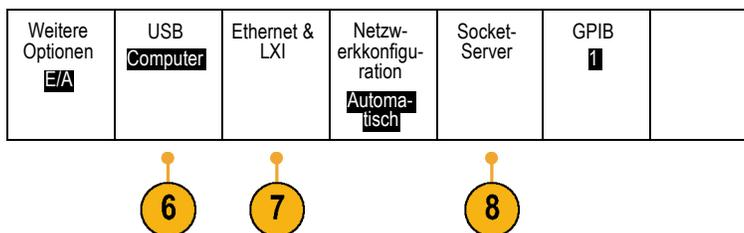
7. Zur Verwendung von Ethernet drücken Sie am unteren Rahmen auf **Ethernet & LXI**. Passen Sie Ihre Netzwerkeinstellungen ggf. mithilfe der seitlichen Rahmentasten an. Weitere Informationen finden Sie weiter unten unter den e\*Scope-Setupinformationen.
