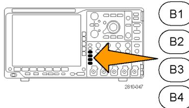
2. Drücken Sie im Trigger-Bereich die Taste **Menu**, und geben Sie die Triggerparameter ein. (Siehe Seite 82, *Auswählen eines Triggertyps.*)
