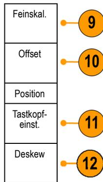
10. Wählen Sie **Offset**, um mit dem Mehrfunktions-Drehknopf **a** die Abstimmung des vertikalen Offsets vornehmen zu können.
