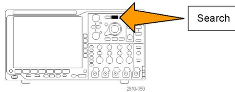
10. Drücken Sie **Suchtyp**. Verwenden Sie den Mehrfunktions-Drehknopf **a**, um **Bus** auszuwählen, und drücken Sie dann auf **Daten**. Legen Sie den Datenwert mit den Mehrzweckknöpfe **n a** und **b** fest.
