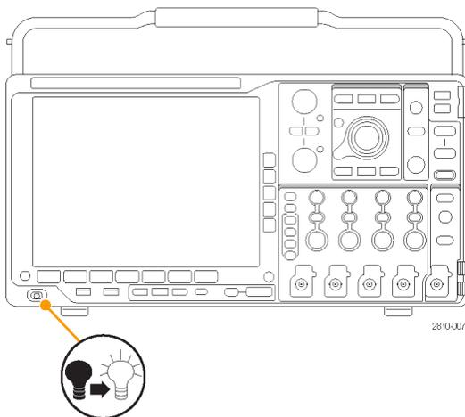
5. Schalten Sie das Oszilloskop aus, und entnehmen Sie das USB-Flash- oder Festplatten-Laufwerk.
