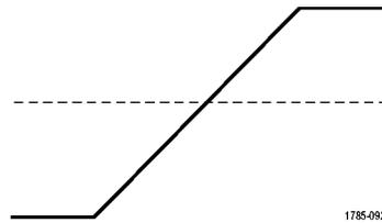
Trigger auf einer ansteigender oder abfallender Flanke, entsprechend der Definition in der Flankensteuerung. Verfügbare Kopplungsarten sind DC, NF-Unterdrückung, HF-Unterdrückung sowie Rauschunterdrückung.
