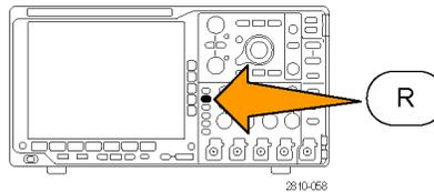
2. Drücken Sie auf dem unteren Rahmen die Taste **R1**, **R2**, **R3** oder **R4**, um das Referenzsignal aus der Anzeige zu entfernen.
