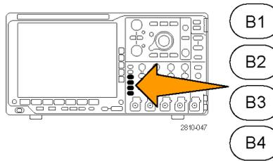
6. Drücken Sie die Taste **Busanzeige** im unteren Rahmenmenü, drücken Sie die Taste **Bus und Signale** im seitlichen Rahmenmenü, und drücken Sie dann im seitliche Rahmenmenü auf **ASCII**.
