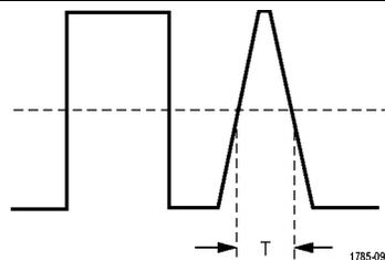
Trigger auf Impulse, die kürzer als, länger als, gleich oder ungleich einer angegebenen Zeit sind. Sie können außerdem triggern, wenn sich eine Impulsbreite innerhalb oder außerhalb eines Bereichs von zwei unterschiedlichen festgelegten Zeiten befindet. Es kann auch auf positive oder negative Impulse getriggert werden. Impulsbreitentrigger werden primär für digitale Signale verwendet.
