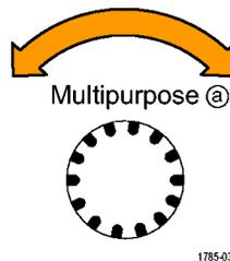
5. Drehen Sie den Mehrfunktions-Drehknopf **a**, um den Kanal zu verschieben.
