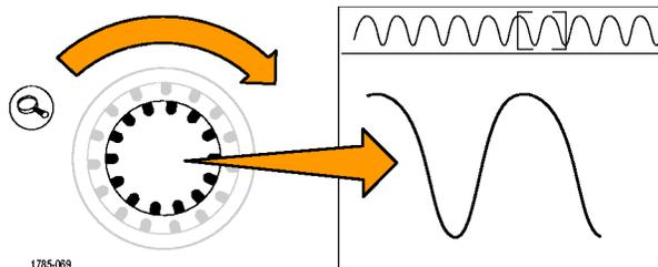
2. Drehen Sie den Knopf **Pan** solange, bis sich die Mitte des Zoomfensters nahe an der Stelle befindet, an der sich der Relaiskontakt öffnet.
