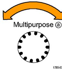
4. Drehen Sie den Mehrfunktions-Drehknopf **b**, um den **Messtyp** von **Schnappschuss** auszuwählen.
