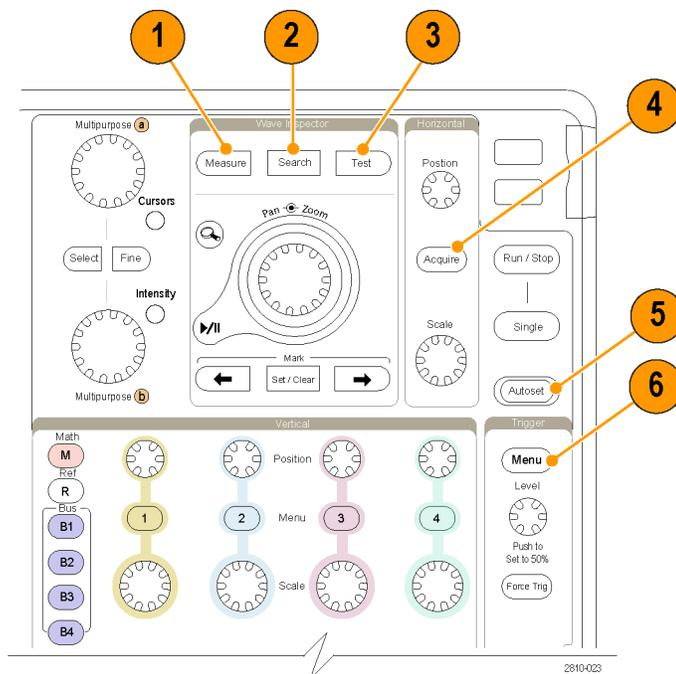
6. **Trigger-Menü.** Drücken Sie diese Taste, um die Trigger-Einstellungen anzugeben.
