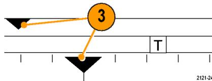
4. Die Signaldatensatzanzeige zeigt die Triggerstelle im Verhältnis zum Signaldatensatz an. Die Linienfarbe entspricht der ausgewählten Signalfarbe. Die Klammern geben den Teil der Aufzeichnung an, der derzeit auf dem Bildschirm angezeigt wird.
