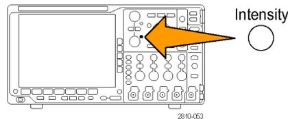
Dadurch wird die Anzeige für die Intensität auf dem Bildschirm angezeigt.
