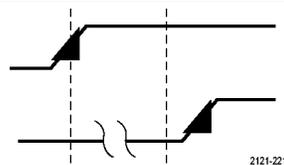
Kombinieren Sie einen A-Ereignis-(Haupt-)Flankentrigger mit dem B-Ereignis-Trigger (verzögert), um komplexere Signale zu erfassen. (Siehe Seite 91, *Verwenden von A- (Haupt-) und B- (verzögerten) Sequenztriggern.*)
