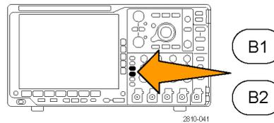
2. Drücken Sie eine Taste auf dem unteren Rahmen, um eine Bezeichnung zu erstellen, z. B. für Kanal 1 oder B1.
