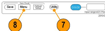
8. **Save / Recall Menu.** Drücken Sie diese Taste, um Setups, Signale und Bildschirmabbildungen in einem internen Speicher, auf einem USB-Flash-Laufwerk oder auf einem eingebundenen Netzlaufwerk zu speichern bzw. von dort abzurufen.
