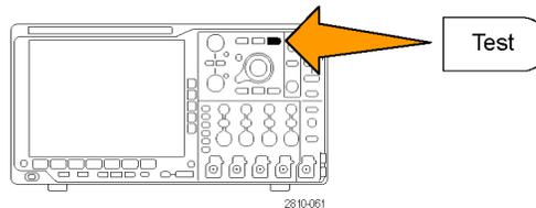
2. Drehen Sie den Mehrzweck-Drehknopf **a**, um **Leistungsanalyse** auszuwählen.
