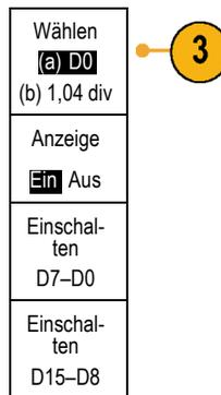
4. Drehen Sie den Mehrfunktions-Drehknopf **a**, um den Kanal auszuwählen, der verschoben werden soll.
