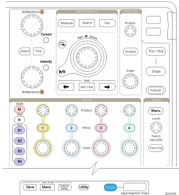
2. Drücken Sie eine der Tasten auf dem unteren Rahmen, um ein Menüelement auszuwählen. Wenn ein Popout-Menü angezeigt wird, wählen Sie mit dem Mehrzweck-Drehknopf **a** die gewünschte Option aus. Wenn ein Popup-Menü angezeigt wird, drücken Sie die Taste erneut, um die gewünschte Option auszuwählen.
