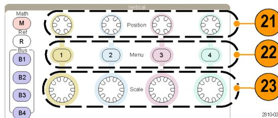
**22. 1, 2, 3, 4.** Drücken Sie die Tasten, um das betreffende Signal anzuzeigen bzw. auszublenden und auf das vertikale Menü zuzugreifen.
