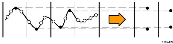
Im **Hi Res**-Modus (hohe Auflösung) wird der Durchschnittswert für alle Abtastwerte eines Erfassungsintervalls ermittelt. Dieser Modus funktioniert nur bei nicht interpolierter Abtastung in Echtzeit. Der Hi Res-Modus bietet ein Signal mit höherer Auflösung und geringerer Bandbreite.
