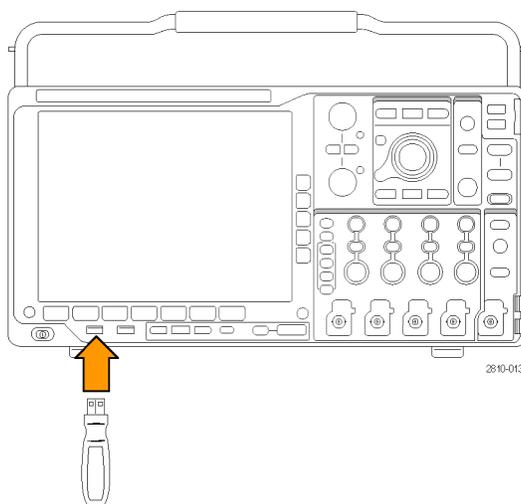
4. Schalten Sie das Oszilloskop ein. Das Gerät erkennt die neue Firmware automatisch und installiert sie.
