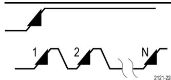
**Ereignisse.** Nachdem Ereignis A aufgetreten ist, sucht das Triggersystem nach Ereignis B, bevor das Signal getriggert und angezeigt wird.
