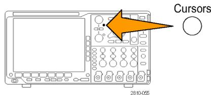
Im Beispiel werden zwei vertikale Cursor auf dem ausgewählten Signal angezeigt. Durch Drehen des Mehrfunktions-Drehknopfs **a** verschieben Sie einen Cursor nach rechts bzw. nach links. Durch Drehen des Mehrfunktions-Drehknopfs **b** verschieben Sie den anderen Cursor.
