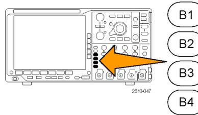
2. Drücken Sie **Bus**. Drehen Sie den Mehrzweck-Drehknopf **a**, um durch die Liste der Bustypen zu blättern und den gewünschten Bus auszuwählen: Parallel (nur Serie MSO4000B), I<sup>2</sup>C, SPI, RS-232, CAN, LIN, FlexRay, Audio, USB, Ethernet oder MIL-STD-1553.
