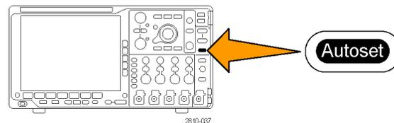
Das Oszilloskop setzt die vertikalen, horizontalen und Triggeroptionen automatisch. Sie können diese Optionen manuell einstellen, wenn Sie die Anzeige des Signals optimieren möchten.
