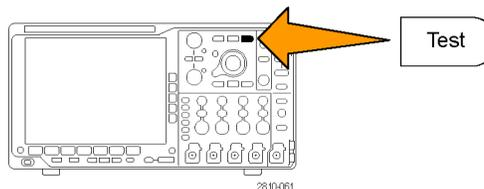
5. Drücken Sie im unteren Rahmenmenü auf **Anwendung**. Drehen Sie den Mehrzweck-Drehknopf **a**, um aus dem Menü **Grenzwert-/Maskentest** auszuwählen.
