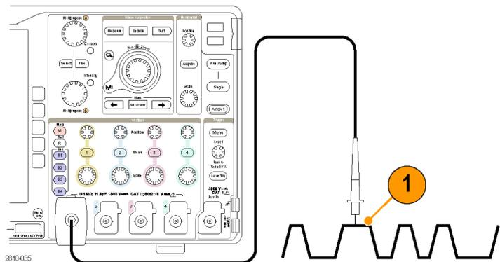
2. Wählen Sie mit Hilfe der Tasten auf der Frontplatte den Eingangskanal aus.
