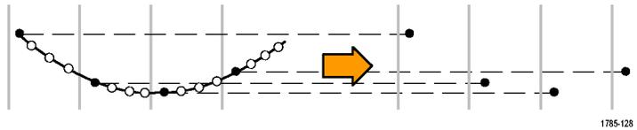
Bei **Spitzenwerterfassung** wird jeweils der höchste und niedrigste Abtastwert aus zwei aufeinanderfolgenden Erfassungsintervallen verwendet. Dieser Modus funktioniert nur bei der nicht interpolierten Abtastung in Echtzeit und ist für das Erfassen von Hochfrequenz-Glitches geeignet.
