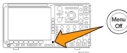
6. Schalten Sie das Oszilloskop aus, und schalten Sie es wieder ein, um den Vorgang abzuschließen.
