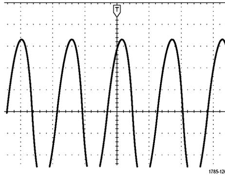
3. Das Symbol für Dehnungspunkte (ein oranges Dreieck) zeigt den Punkt an, an dem sich die horizontale Skalierung dehnt und komprimiert.
