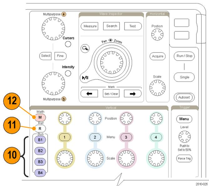
Drücken Sie außerdem die Taste **B1**, **B2**, **B3** oder **B4**, um den entsprechenden Bus auf dem Display anzuzeigen oder von dort zu entfernen.
