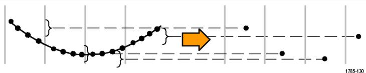
Der Modus **Hüllkurve** identifiziert die höchsten und niedrigsten Aufzeichnungspunkte bei allen Erfassungen. Für die einzelnen Erfassungen wird die Spitzenwerterfassung verwendet.
