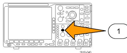
Zur automatischen Einstellung eines digitalen Kanals schließen Sie den Logiktastkopf an und wählen Sie den Eingangskanal aus. (Siehe Seite 75, *Einrichten digitaler Kanäle*.)
