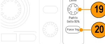
20. **Force Trig** (強制トリガ)。このボタンを押すと、イベントをただちに強制的にトリガします。
