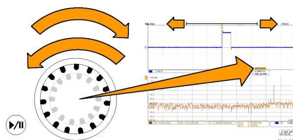
当示波器正在采集数据（正在运行）时如果旋转平移控制，则可以同时移动频谱时间和射频采集时间。这就像沿着频谱时间拖动射频采集时间一样。
