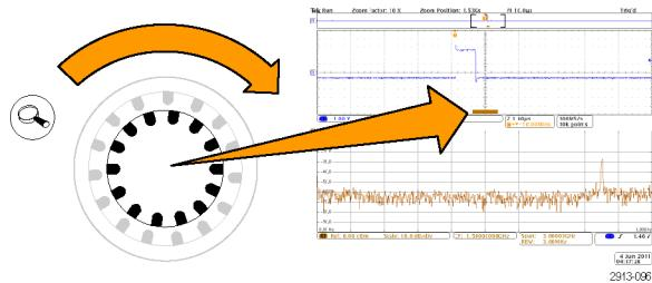
可使用缩放控制更近地观察模拟时间以及时间相关多域显示。
