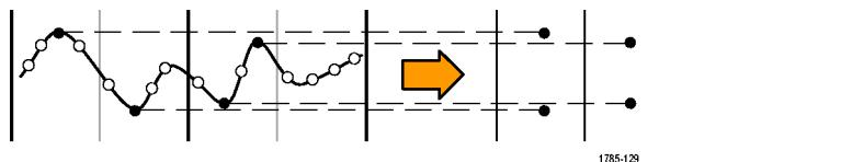
**高分辨率**模式计算每个采集间隔所有取样值的平均值。该模式也只能用于实时、非内插取样。高分辨率模式提供了较高分辨率、较低带宽的波形。
