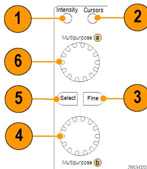
4. 激活时，旋转下方通用旋钮 b，可以移动光标或设置菜单项的数字参数值。按“精细”可以更缓慢地进行调整。
