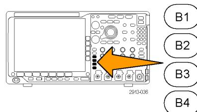
2. 按“总线”。旋转通用旋钮 a 滚动可用的总线类型列表, 并选择所需的总线: 并行、I<sup>2</sup>C、SPI、RS-232、CAN、LIN、FlexRay、音频、USB、以太网或 MIL-STD-1553。
