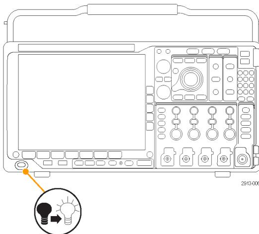
5. 关闭示波器电源并移除 USB 闪存或硬盘驱动器。
