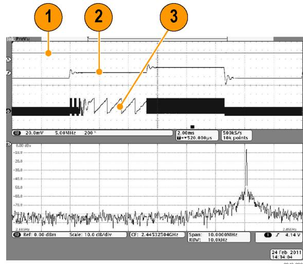
频率对时间波形手柄（基线指示器）表示中心频率。当光迹位于波形手柄之上时，它处于中心频率之上。当光迹位于波形手柄之下时，它处于中心频率之下。
