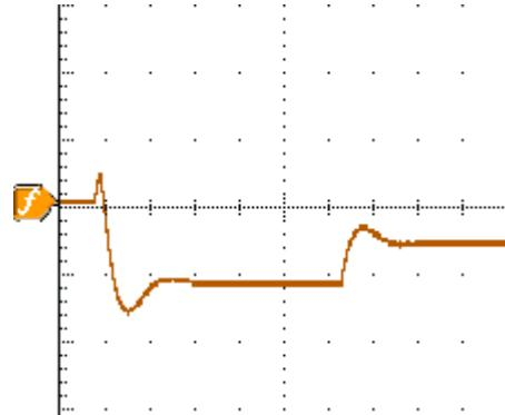
当射频输入的幅度低于用户指定的值时，使用静噪可抑制（不显示）相位和频率信息。当射频输入上没有信号时，这可避免频率对时间以及相位对时间光迹显示为噪声的宽频带。
