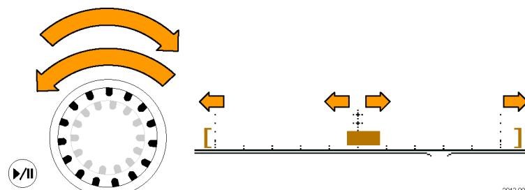
顺时针方向旋转平移旋钮时，将向显示的右边移动射频采集时间和频谱时间。当射频采集时间的右侧到达屏幕的右侧时，就无法再向右边移动射频采集时间了。
