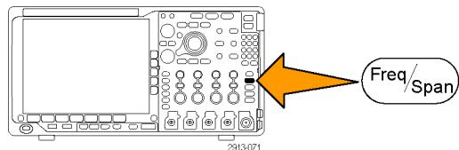
2. 在侧面菜单中按“中心频率”，使用通用旋钮 **a** 或示波器键盘输入所需的中心频率。如果使用键盘，也可以使用出现的侧面菜单选择来输入单位。
