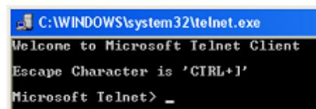
11. 使用示波器的 LAN 地址和端口号键入一个打开命令，在计算机和示波器之间启动一个终端会话。
