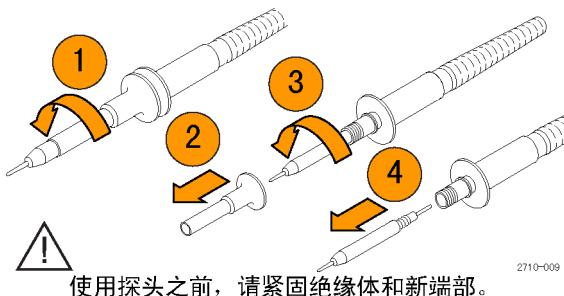
使用探头之前, 请紧固绝缘体和新端部。
