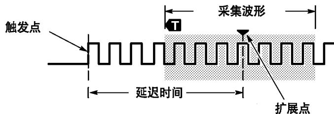
当“延迟”设为“开启”时，顺时针旋转“水平位置”旋钮增加延迟。触发点将向左边移动，最终达到采集的波形之外。然后，可调整“水平比例尺”旋钮来采集屏幕中央兴趣区周围的更多细节。
