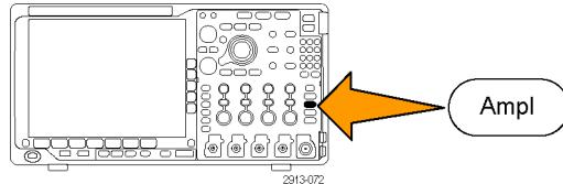
2. 按“参考电平”并旋转通用旋钮 **a** 来设置近似的最大功率电平，如频率格线顶端的基线指示器所示。
