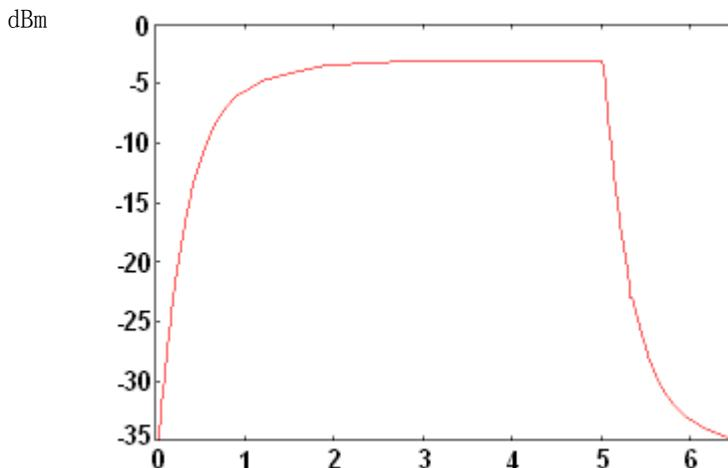
右图中在  $-35 \text{ dBm}$  触发电平上，在突发脉冲的开始处与触发之间有一个最小延迟。时域格线中显示的射频幅度与时间光迹显示出此射频突发脉冲的轮廓。
