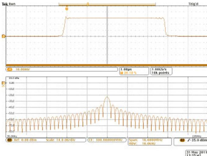
在右图中，边沿触发功率电平现在上升为 -10 dBm。触发指示从突发脉冲的开始处延迟了大约 500 ns。原因就是上面所讨论的功率检测器响应。
