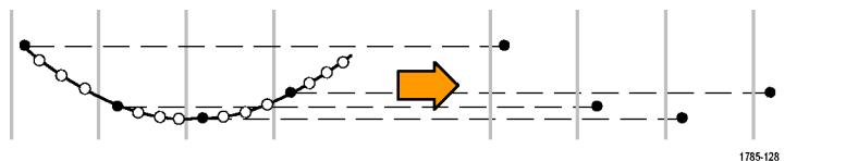
**峰值检测**模式使用了两个连续捕获间隔中包含的所有取样的最高和最低点。该模式仅可用于实时、非内插的取样，并且在捕获高频率的毛刺方面非常有用。
