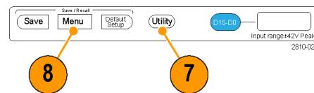
8. Save/Recall (保存 / 调出) 菜单。按下可保存和调出内部存储器、USB 闪存驱动器或已装载网络驱动器内的设置、波形和屏幕图像。
