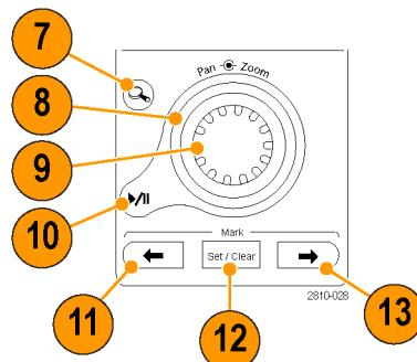
10. **播放/暂停按钮**。按此按钮可以开始或停止波形的自动平移。使用平移旋钮控制速度和方向。
