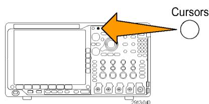
在本例中，选定的波形上将出现两个垂直光标。旋转通用旋钮 a 时，可以将一个光标向左或右移动。旋转旋钮 b 时，可以移动另一个光标。
