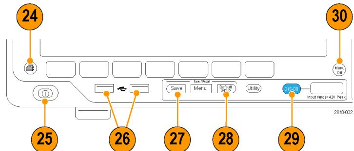
**26. USB 2.0 主机端口。**在此插入 USB 电缆可将外设连接到示波器，例如键盘、打印机或闪存驱动器。在后面板上也有两个 USB 2.0 主机端口。
