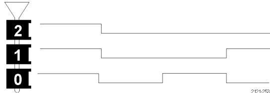
18. 总线显示表示串行总线或并行总线的解码后的包级别信息。总线显示器显示总线编号和总线类型。
