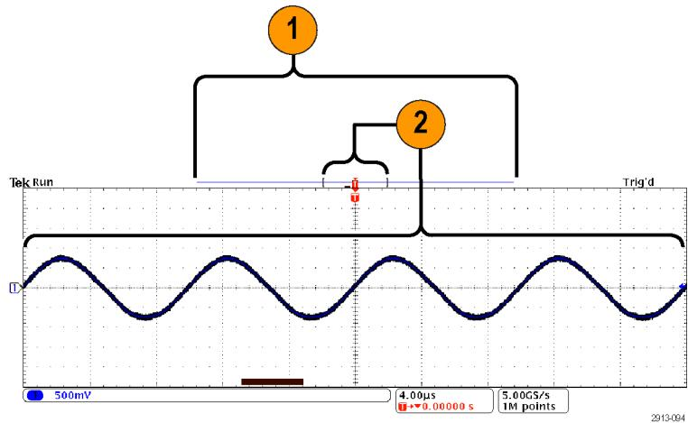
**说明：**如果同时使用频域和自动放大功能，并且将频谱时间移到格线所示采集部分以外，则时域显示内表示频谱时间的橙色条会消失，频域显示内的任何活动都将消失。
