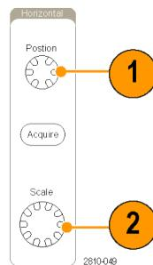
2. 旋转水平“标度”以采集所需的围绕位置（延时）扩展点的细节。
