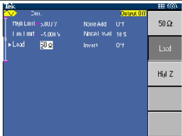
**HINWEIS.** Sofern als Einheit der Ausgabeamplitude ein dBm-Wert festgelegt ist, wird die Einstellung der Amplitudeneinheit automatisch zu Vpp geändert, wenn Sie eine hohe Impedanz wählen.
