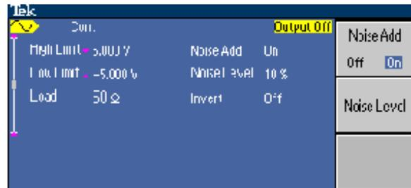
**HINWEIS.** Wenn Sie Noise Add (Rauschen hinzufügen) auf On (Ein) einstellen, wird die Amplitude des Ausgangssignals auf 50 % gesenkt.
