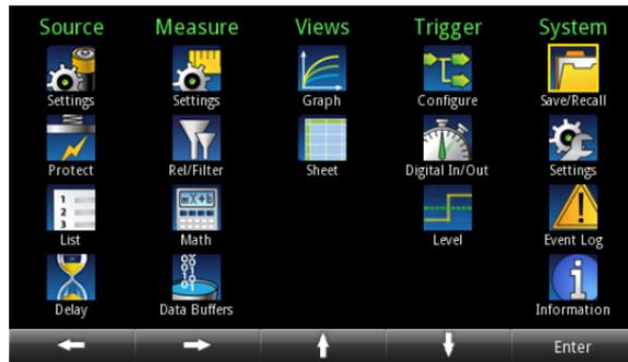
À partir de là, vous pouvez sélectionner les menus de source, de mesure, d'affichage, de déclenchement et de configuration du système. Ces menus vous permettent de sélectionner des options pour configurer votre instrument en fonction de vos applications. Sélectionnez une option de menu en les faisant défiler à l'aide des commandes de navigation ou en utilisant les flèches pour mettre une icône en surbrillance. Appuyez ensuite sur **ENTER** (ENTRÉE).
