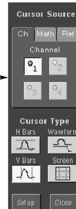
3 Drücken Sie **Setup**, und platzieren Sie die Cursor mit den Mehrfunktions-Drehknöpfen, oder geben Sie die Cursorpositionen numerisch ein.
