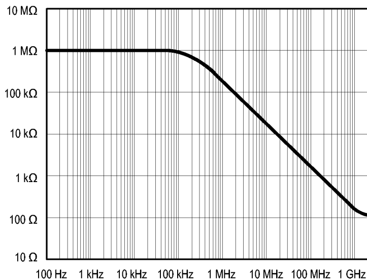
Рис. 5: Типичная зависимость входного сопротивления от частоты
