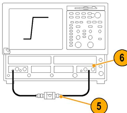
7. Установите блок измерений канала 1/2 в режим TDR: Нажмите кнопку **SETUP DIALOGS** (диалоги настройки) и выберите вкладку TDR.
