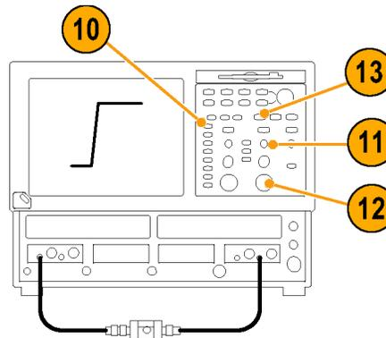
**ПРИМЕЧАНИЕ.** При проведении калибровочных измерений не прикасайтесь к адаптеру для наконечника пробника ВЧ. При манипуляциях с адаптером наконечника пробника точность измерений ухудшается.
