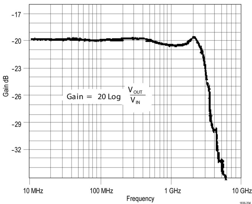
**Рис. 2: Типичная полоса пропускания пробника TAP2500**
