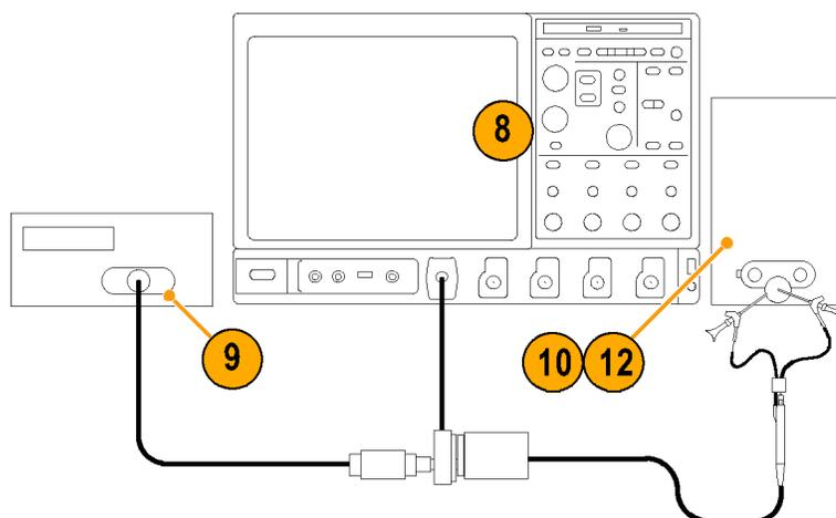
**ПРИМЕЧАНИЕ.** Недопустимое значение погрешности может возникнуть, если в качестве нагрузки не используется прецизионная согласованная нагрузка 50 Ом или если смещение осциллографа не установлено равным нулю.
