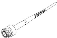
**Выходной провод.** Выходной разъем BNC, подключаемый к осциллографу, откалиброван для обеспечения выхода на высокоимпедансную нагрузку (1 МОм).
