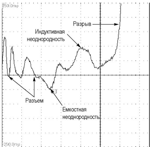
**Рис. 14: Осциллограмма TDR для примера с неоднородностями в микрополосковой линии**
