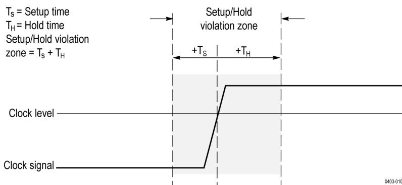
建立时间/保持时间触发使用建立时间/保持时间违规区来检测在过于接近定时时间时数据不稳定的时间。每次触发释抑结束后，仪器将监测数据和时钟源。发生时钟边沿时，仪器将检查它针对建立时间/保持时间违规区内发生的跳变所处理的数据流（来自数据源）。如果发生任一情况，仪器将使用位于时钟边沿的触发点触发。
