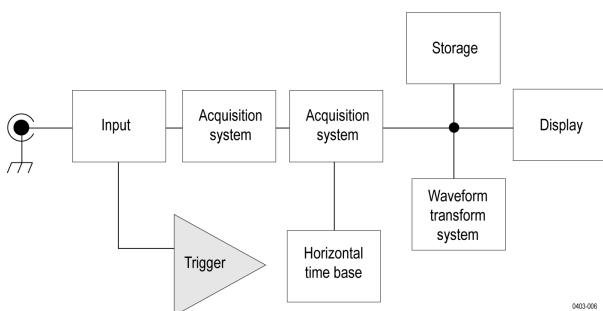
触发可帮助您捕获要在屏幕上显示的有意义的波形。仪器具有一些简单的边沿触发以及各种高级触发。
