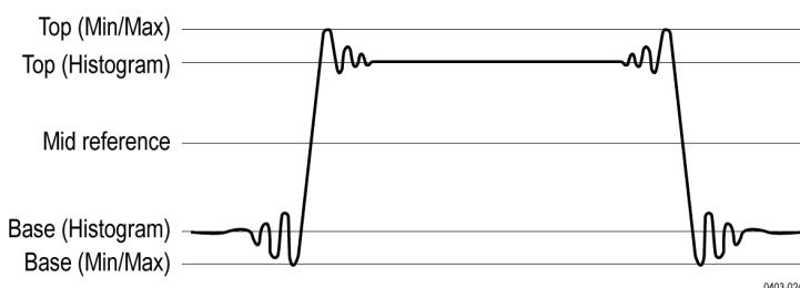
**直方图平均值**利用直方图分析方法，通过使用波形中点上方和下方的所有值计算平均值。“最高值”设置为高平均值，“最低值”设置为低平均值。此设置最适合检查眼图和光信号。
