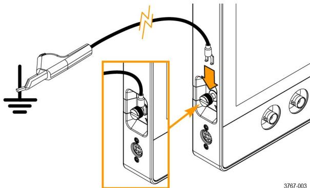
如果选择不连接接地线，则将示波器连接危险电压时将缺少防电击保护。如果没有在探头端部、BNC 连接器中心或公用导线上连接大于  $30 \text{ V}_{\text{RMS}}(42 \text{ V}_{\text{pk}})$  的信号，则仍可以使用示波器。确保所有的探头公共导线连接到相同的电压上。
