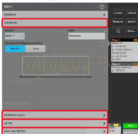
4. 使用可用字段优化测量条件。所显示的字段将取决于测量。选项更改将立即生效。选项更改也还会更改其他面板中的字段。
