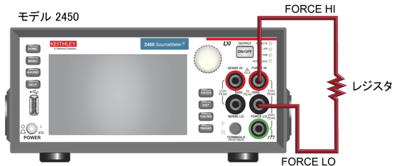
図 19:2450 型の 2 線フロント パネル接続
