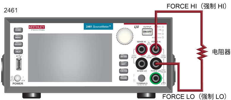
图 19：2461 型 2 线前面板连接
