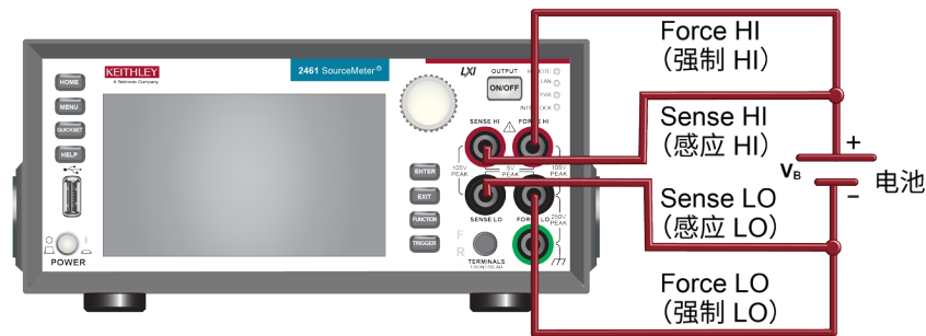
图 29：用于电池放电-充电的前面板连接
