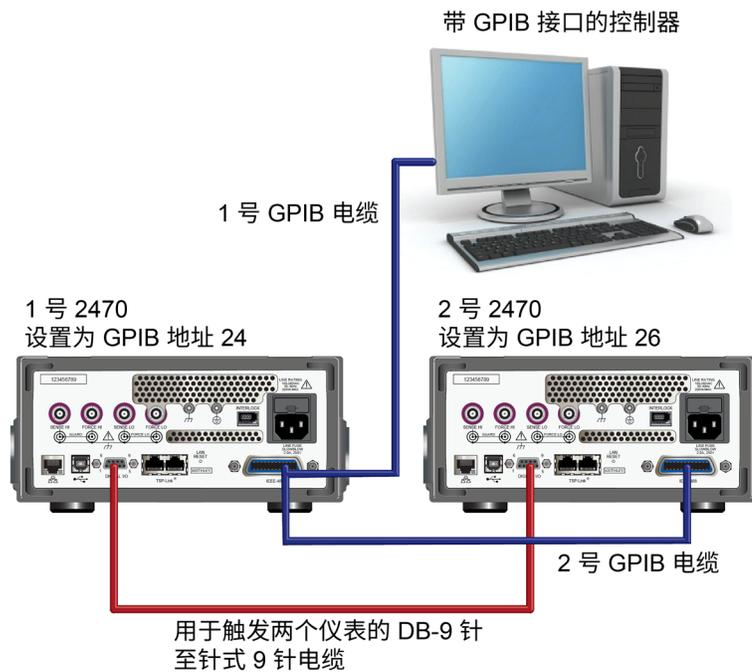
上图还显示了使用 GPIB 远程通信接口时的通信电缆连接。1 号 GPIB 电缆将计算机（控制器）上的 GPIB 端口连接到 1 号 2470 后面板上的 IEEE-488 连接器。2 号 GPIB 电缆连接两台 2470 的 IEEE-488 连接器。
