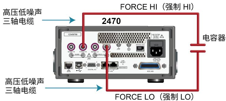
图 23：后面板连接绝缘电阻测试
