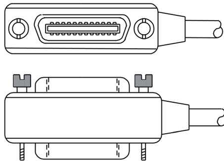
要建立与一台仪器的多个并行连接，请堆叠各连接器。每个连接器上都有两个螺丝，以确保牢固地连接。下图显示了对应于含多台仪器的测试系统的典型连接图。
