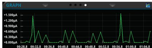
要以全屏查看图形并访问图形设置，请选择滑动屏幕标题右侧的图形图标。也可以通过按 **MENU** (菜单) 键并在 Views (视图) 下选择 **Graph** (图形) 来打开完整功能 Graph (图形) 屏幕。
