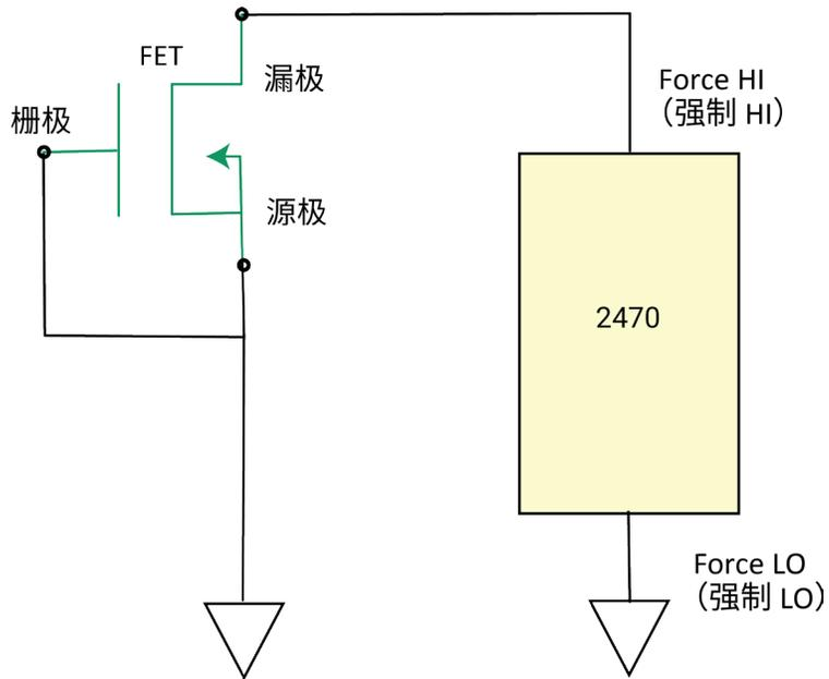
下图显示了从 2470 的后面板端子进行的连接。
