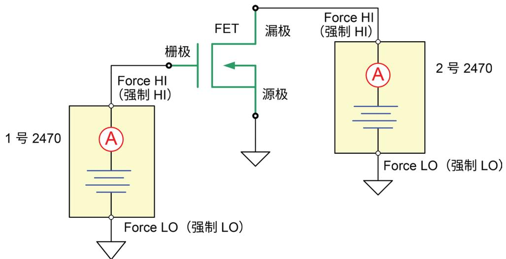
下图显示了从两台 2470 的后面板端子到 FET 的连接。
