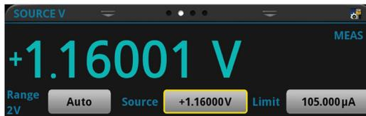
屏幕右侧的源功能指示器表示对显示的源值有影响的设置：
