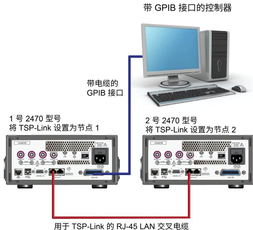
若要从计算机到 2470 仪器进行 GPIB 通信，从 GPIB 接口到 2470 IEEE-488 接口之一（上图中的 1 号 2470）只需要一根电缆。
