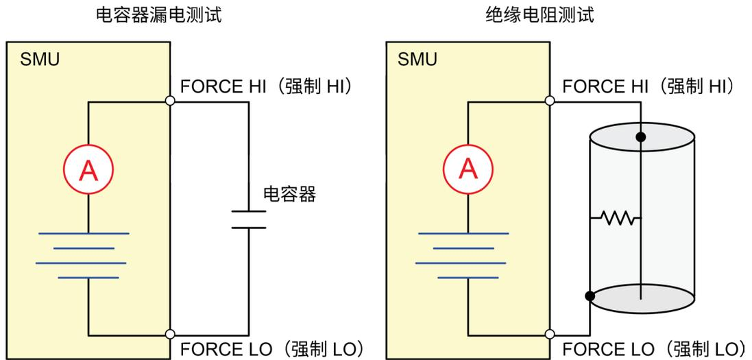
下图显示了在这些应用中与被测器件 (DUT) 的后端子连接。如果电容器漏点测量有噪声，您可能需要使用高电容模式或添加与电容器串联的低漏电正向偏置二极管。
