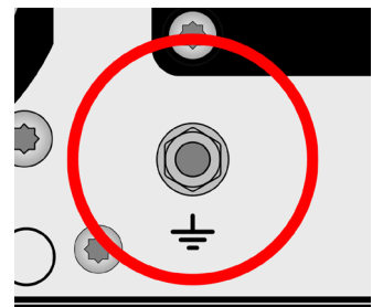
Figure 12 - Point de mise à la terre
