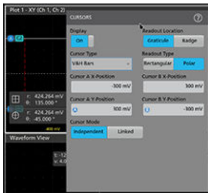
Menu de configuration du curseur dans un tracé XY.
