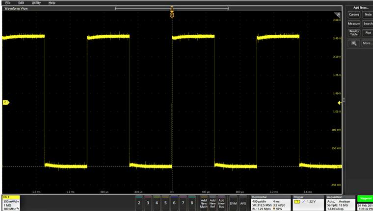
使用 **Overlay Display** (覆盖显示) 模式时, 仪器调整触发源通道的水平和触发设置以便显示此通道的已触发波形。Overlay Display (覆盖显示) 模式下所有活动通道的垂直标度和位置调整均由 **User Preferences** (用户首选项) 菜单的 **Autoset** (自动设置) 面板中的 **Autoset in Overlay Display Mode Optimizes** (在覆盖显示模式中自动设置优化) 选项控制。如果选项为 **Visibility** (可视性), 自动设置将垂直标定和定位所有活动通道波形使它们在屏幕上均匀隔开。如果选项为 **Resolution** (分辨率), 自动设置将垂直标定和定位所有活动通道波形使它们均尽量多使用 ADC 的范围。
