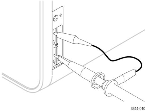
将探头端部连接至 1 kHz 信号源并将接地夹接地。为获得最佳效果，请取下所有探头端部附件并将探头端部直接连接至 1 kHz 连接器。
