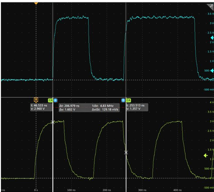
5. 要进一步配置光标，请双击光标线或光标读数打开 **Cursors (光标)** 配置菜单。例如，点击 **Cursor (光标)** 类型选择要显示的光标，如 **Waveform (波形)**、**V Bars (竖条)**、**H Bars (横条)** 以及 **V&H Bars (竖条和横条)**。请参阅 [光标配置菜单](#)。
