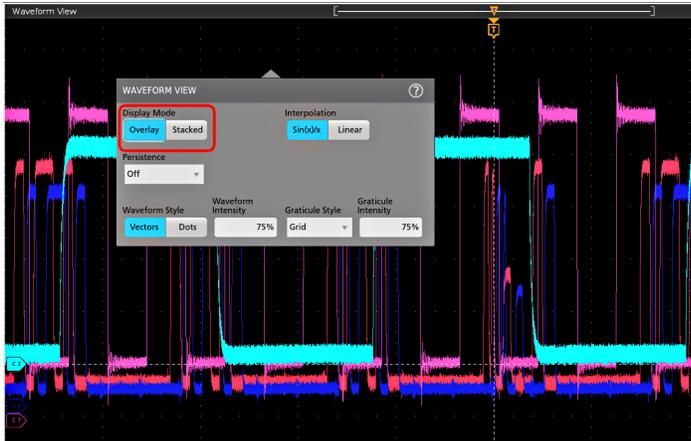
3. Verwenden Sie die anderen Steuerelemente, um den Algorithmus für die Interpolation der Signale, das Nachleuchten, die Darstellung und die Intensität der Signalpunkte sowie die Rasterform und -intensität einzustellen.
