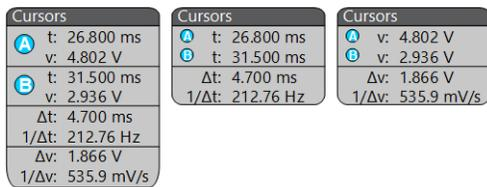
Um ein Cursor-Messwertanzeigenbadge zu erstellen, schalten Sie **Cursors** (Cursor) ein, tippen Sie doppelt auf eine Cursor-Messwertanzeige, um das entsprechende Konfigurationsmenü zu öffnen, und stellen Sie den Modus **Readouts** (Messwertanzeigen) auf **Badge**.
