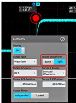
Das Cursor-Konfigurationsmenü in einem XY-Diagramm.
