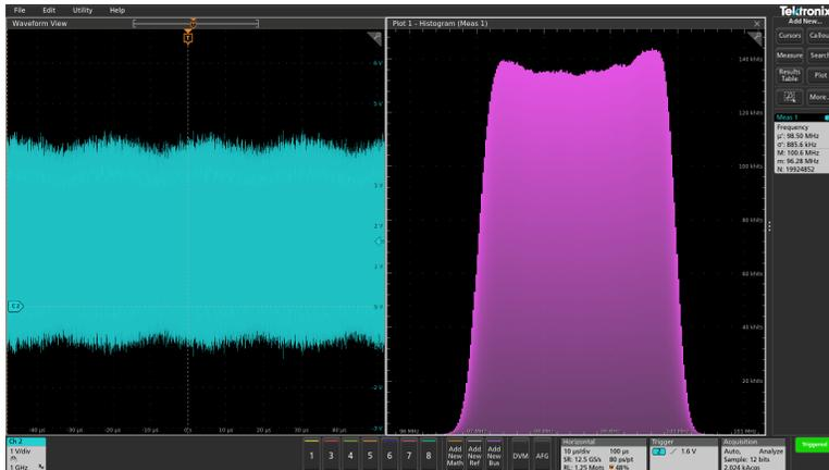
Sie können Messungen mehr als eine Darstellung hinzufügen (zu verschiedenen Messungen oder zu der gleichen Messung). Sie können z. B. zwei Histogrammdarstellungen für dieselbe Messung hinzufügen und eines so einstellen, dass die X-Achse mit einer logarithmischen Skala angezeigt wird, während die andere Darstellung die X-Achse mit einer linearen Skala anzeigt.
