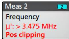
Verändern Sie die Vertikalskala, um die Nachricht der Signalbegrenzung zu schließen und das gesamte Signal abzubilden. Trennen Sie außerdem die Verbindung zwischen Tastkopfspitze und der Quelle mit zu hoher Spannung und überprüfen Sie, ob Sie das korrekte Signal mit dem korrekten Tastkopf überprüfen.
