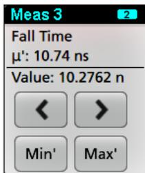
Die Schaltflächen < (Zurück) und > (Weiter) zentrieren das Signal in der Anzeige an der Position des vorherigen oder des nächsten Messpunkts in der Aufzeichnung (bei Messungen, die mehr als eine Messung pro Erfassung beinhalten).
