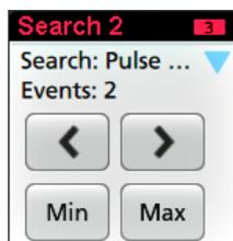
Einige Suchen bieten auch **Min** und **Max** Navigationsschaltflächen, mit denen der Zoom-Modus geöffnet und das Signal in die Mitte des Bildschirms auf den Minimal- oder Maximalwert für dieses Suchereignis in der aktuellen Erfassung bewegt werden kann.
