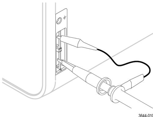
Schließen Sie die Tastkopfspitze an die 1-kHz-Quelle und die Erdungsklemme an die Erdung an. Entfernen Sie für optimale Messergebnisse jegliches Zubehör der Tastkopfspitze und halten Sie die Tastkopfspitze direkt an den 1-kHz-Anschluss.
