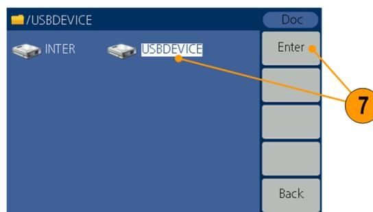
8. 汎用ノブを回してダウンロードしたファームウェア・ファイルを選択します。次に、実行を押してファームウェアを更新します。
