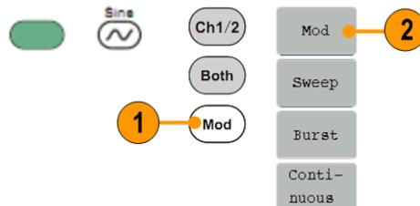
2. 按 Mod(调制)屏幕按钮。在本例中，用正弦波形作为输出波形(载波)。
