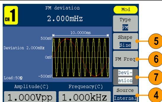
**说明：**偏移量和载波频率的和必须小于或等于当前载波频率上限和 1kHz 之和，对于外部源，偏移量由 Modulation In 接口上的电平控制。+5V 加上所选偏差，-5V 减去所选的偏差。
