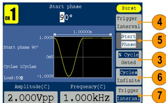
7. 按下 Trigger(触发源)选择触发源。Internal(内部)是使用内部信号源。External(外部)是使用后面板Ext Trig/Burst/Fsk In输入的信号源。选择外部时,可按下Slope(斜率)屏幕按钮选择正或负。Manual(手动)是选择手动触发,按一下前面板的通用旋钮触发一次。
