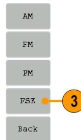
4. 出现 FSK 参数设置屏幕。选择 Internal(内部)或 External(外部)作为 FSK 信号源。
