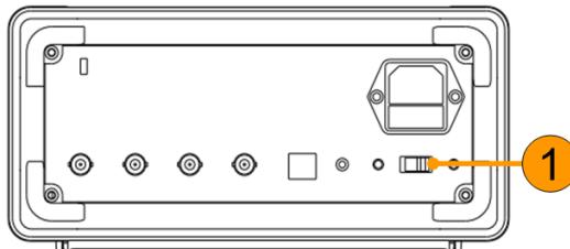
2. 插入 AC 电源线前请将电源插座上的标签剥掉。如果需要，根据电源选择器的设置更换保险丝（保险丝的更换步骤请参阅附录 A）。将交流电源线插入后面板上的电源插座内，另一端插入正确接地的电源插座。
