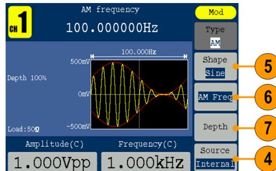
5. 按 Shape(调制波形)切换选择 Sine(正弦)，Square(方波)，Ramp(锯齿波)，Noise(噪声)，Arb(任意波)作为调制波形。
