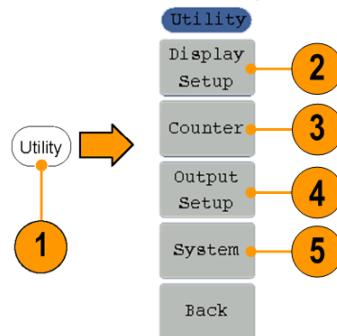
6. 按Display Setup(显示设置)屏幕按钮以显示子菜单。
