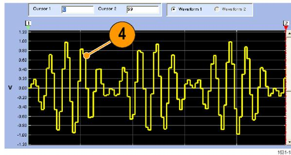
5. Speichern Sie das Signal im .tfw-Format. Kopieren Sie die Signaldaten in einen USB-Speicher, und laden Sie das Signal in den Arbiträrsignal-/Funktionsgenerator.
