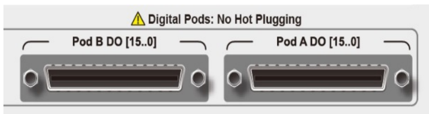
Рис. 2 Соединители цифровых выходов.
