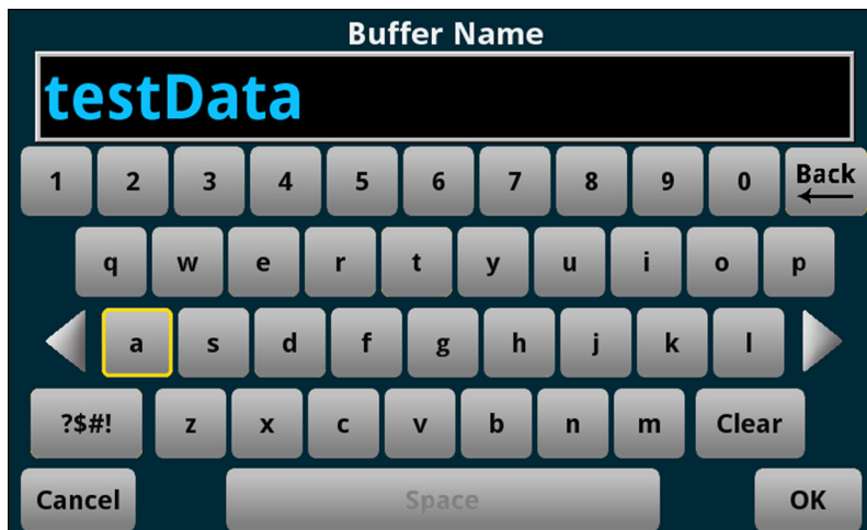
Abbildung 3: Tastatur des vorderen Bedienfelds des DMM7510
