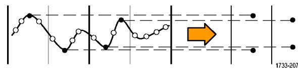
**Hi Res** モードでは、各アクイジション間隔にあるすべてのサンプルの平均が計算されます。ハイレゾは、高分解能で低帯域幅の波形を表示します。
