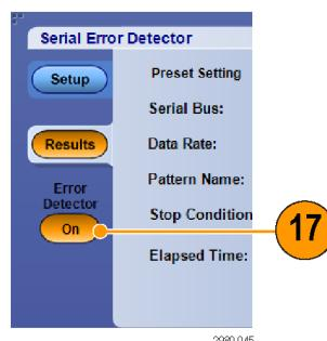
一般的な使用方法をまとめると、a) プリセット・セットアップを選択し、b) Sync を押し、c) Learn を押し(表示されている場合)、次に d) Run を押します。同期動作でオシロスコープと信号を同期し、学習動作で信号パターンをオシロスコープのメモリに取り込み、実行動作でエラー・ディテクタのエラー・テストが開始します。学習動作は、一部のビット・エラー・テストに適用されるのみであることに注意してください。フレーム、シンボル、およびキャラクタ・エラー・テストでは学習動作は必要ありません。
