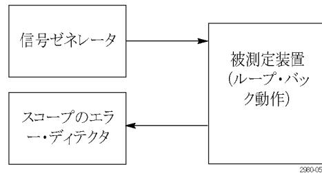
20. 学習動作後にケーブルを接続し直さなくとも済むようにするため、信号ゼネレータの出力を分岐して、1 本をエラー・ディテクタに、もう 1 本を DUT に接続する場合があります。この場合、学習動作は Ch1 で行いますが、実際のエラー検出は Ch2 で行います。信号分割による損失を考慮して、信号ゼネレータの振幅を調整します。この接続方法が正常に機能するのは、エラー・ディテクタの学習動作では、信号テスト・パターンがチャンネル固有ではないメモリに格納されるからです。
