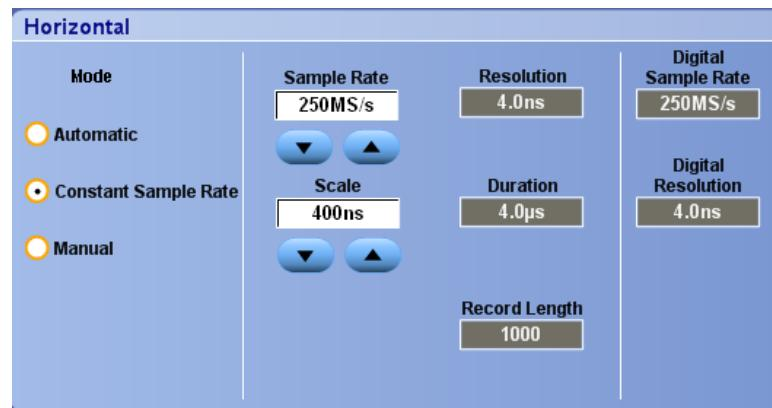
Manual モードでは、サンプル・レートとレコード長を設定できます。水平スケールは従属変数で、サンプル・レートとレコード長から計算されます。
