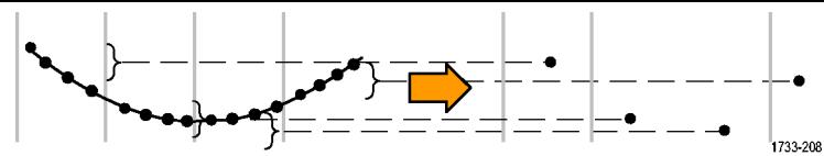
**Envelope** モードでは、多くのアクイジションから最大および最小のレコード・ポイントが特定されます。エンベロープ・モードでは、各アクイジションにピーク・ディテクトを使用します。
