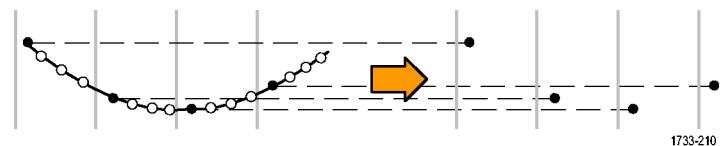
**Peak Detect** モードでは、連続した 2 つのアクイジション間隔に含まれるすべてのサンプルの最大および最小のサンプルが使用されます。このモードは、補間のないリアルタイムのサンプリングでのみ使用でき、高周波数のグリッチを捉捉するのに便利です。
