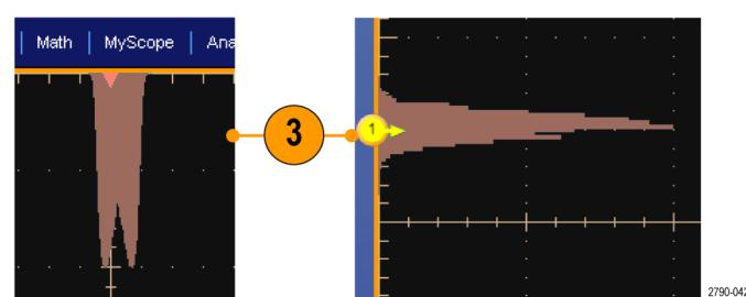
4. ヒストグラムのスケール、またはヒストグラム・ボックスのサイズおよび位置を調整するには、Measure > Waveform Histograms を選択して、Histogram Setup コントロール・ウィンドウを使用します。
