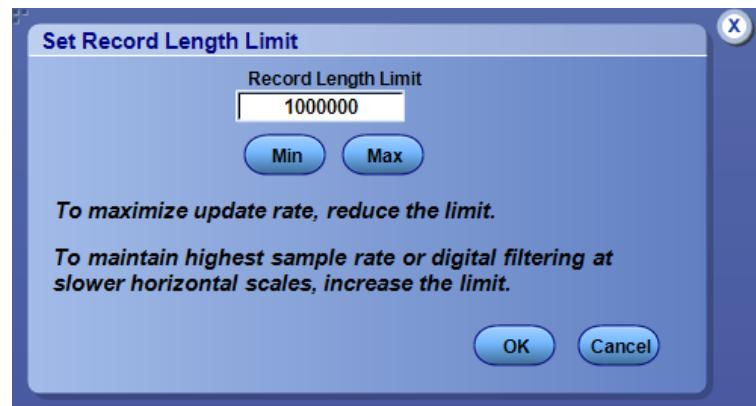
Constant Sample Rate モードでは、サンプル・レートとスケールを設定できます。デフォルトのサンプル・レートを使用すれば、帯域幅フィルタの操作を確実に行うことができます。レコード長は従属変数です。最大レコード長は、機器のモデルとレコード長オプションによって異なります。
