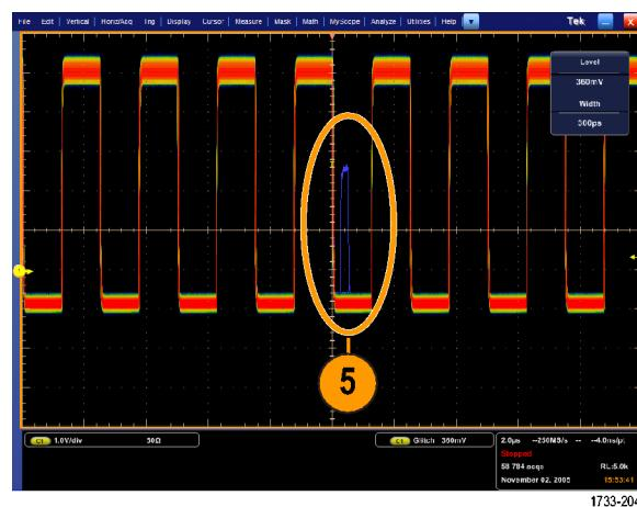
6. ステップ 5 で特定したグリッチでトリガるために、Glitch Setup... を選択します。
