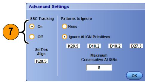
8. Align プリミティブを無視するには、Ignore Align Primitives オプション・ボタンを選択し、キーパッドかキーボードを使用してプリミティブを指定します。
