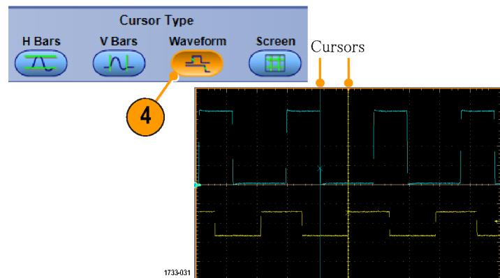
5. **Cursors > Cursor Position...** を選択し、汎用ノブを使用してカーソル位置を調整します。
