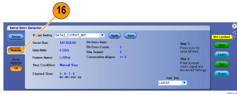
提供された AWG 信号パターンのいずれかを使用している場合は、AWG の Force Event ボタンを押すと、信号にエラーを追加してエラー・ディテクタの動作を確認することができます。これらの AWG セットアップ・ファイルは Win7 の C:\User\Public\Tektronix\EErrorDetector\AWG にあります。
