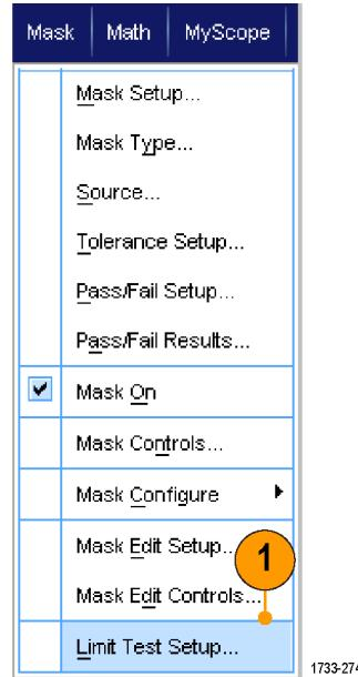
2. Source、Destination、および Tolerances を選択して、テンプレートを作成します。汎用ノブを使用して、Tolerances を調整します。Tolerances は、信号がリミット・テストでフェイルになるまでに許容されるマージンを指定します。
