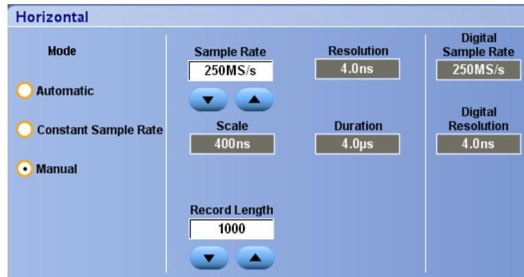
ここで示すように、3つのモードはすべて、サンプル・レート、スケール、およびレコード長と連動しています。水平ラインは、最大リアルタイム・サンプル・レートです。階段状の各ラインは、スケールを増やすと、サンプル・レートは、最大レコード長または設定したレコード長制限値に達したときに小さくなっています。Manual モードは、最大レコード長を使用します。
