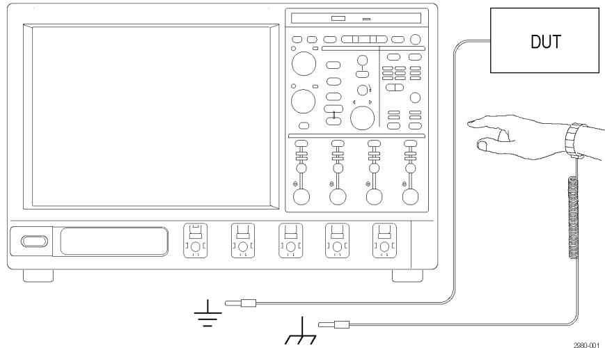
2. ベンチ上で未接続のままになっているケーブルが、大きな静電気の発生原因となることがあります。テストで使用する機器または装置にケーブルを接続する前に、ケーブルの中心導体を一瞬接地するか、片端に  $50 \Omega$  ターミネーションを接続して、すべてのケーブルから静電電圧を放電してください。
