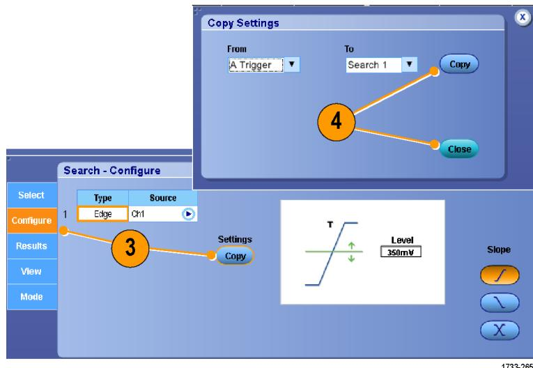
5. 現在のセットアップを変更するには、表示されているコントロールの設定を調整します。表示されているコントロールは、選択した検索の種類によって異なります。
