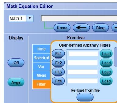
6. 使用するフィルタのフォルダをダブルクリックします。使用するフィルタをダブルクリックします。
