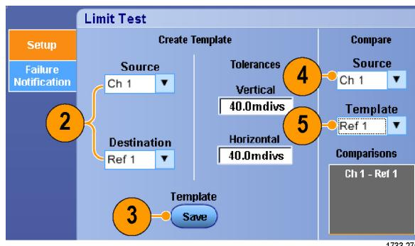
6. Failure Notification をクリックし、エラー通知をセットアップします。
