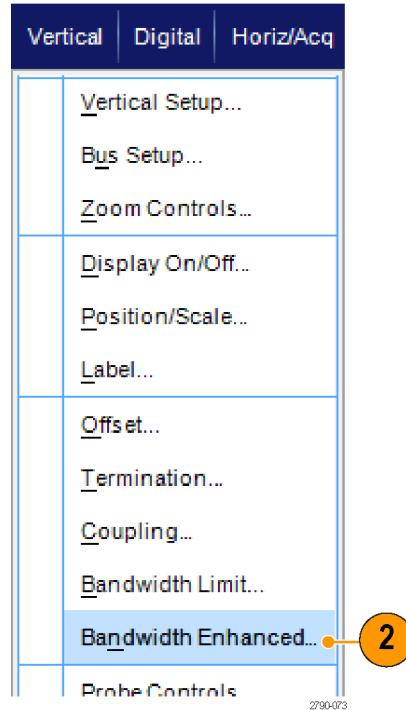
3. Digital Filters (DSP) Enabled をクリックして、拡張帯域幅をオンにします。DSP を有効にするには、サンプル・レートを正しく設定する必要があります。
