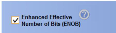
1. ENOB のオン／オフを切り替えるには、Enhanced Effective Number of Bits チェック・ボックスをクリックします。このコントロールは、Horizontal/Acquisition コントロール・ウインドウの Acquisitions タブにあります。
