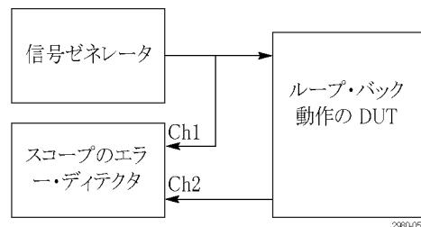
21. ユーザ・インターフェースでエラー・ディテクタを開始すると、バス・デコードが自動的に有効になり、可能な場合は常にバス・トリガが使用されます。デコードにより、右のスクリーン・ショットに示すように、信号のエラー箇所のデコード値が赤でハイライトされます。オシロスコープの他のチャンネルを使用して、他の信号を同時にプローブすることにより、エラー原因のデバッグを行うことができます。
