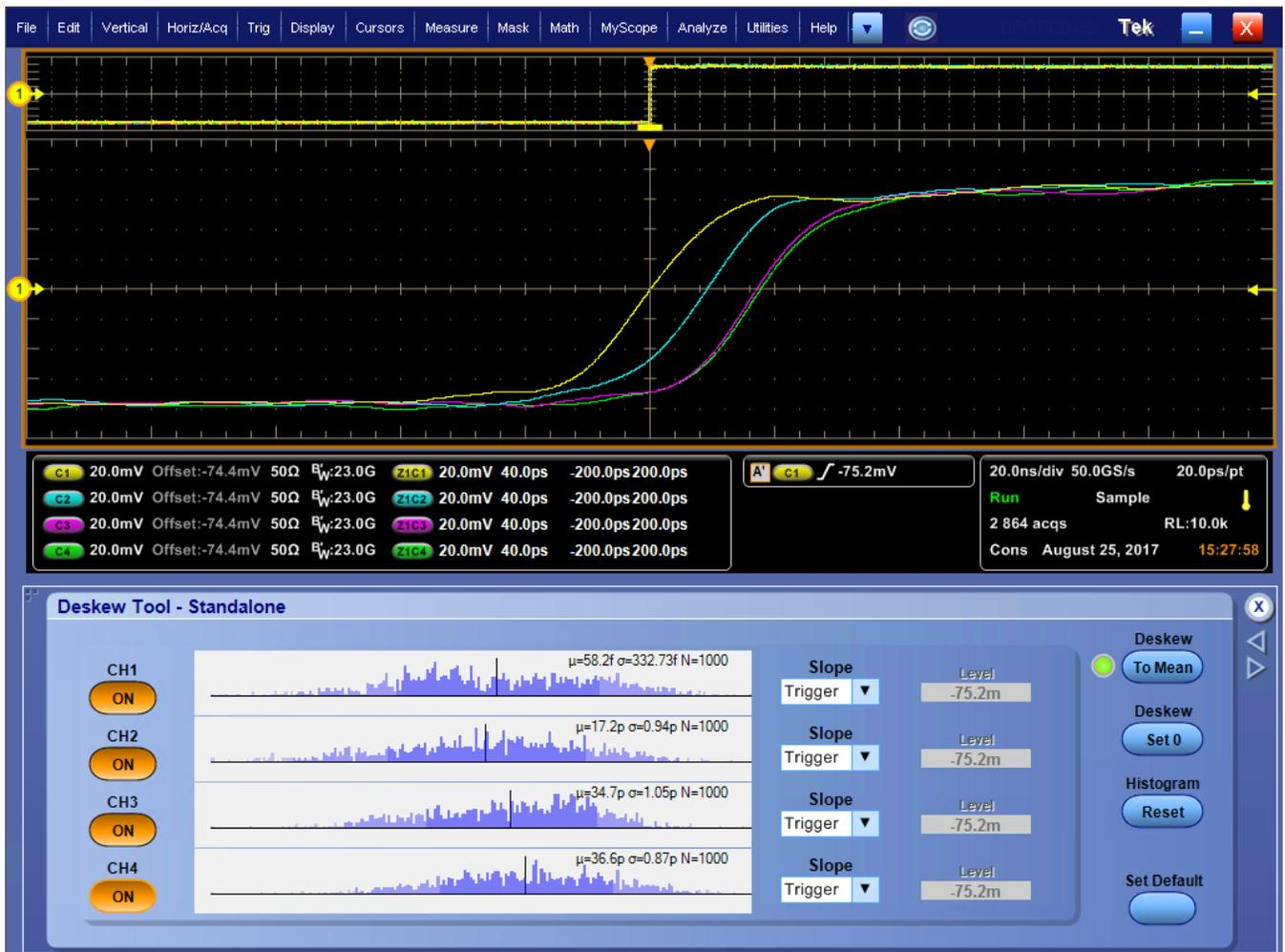
Diese Abbildung ist ein Beispiel für Signale mit schneller Flanke nach dem Versatzausgleich:
