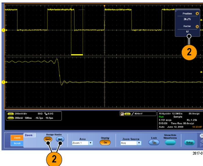
3. 如果要調整縮放方格圖尺寸，請從「垂直」或「水平/擷取」功能表選取「縮放方格圖尺寸」。
