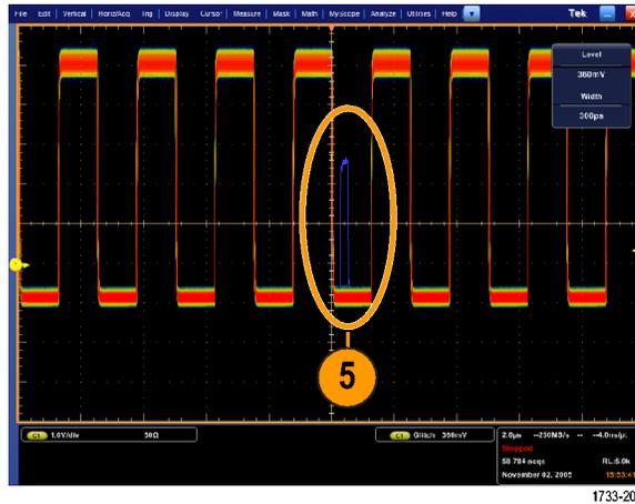
6. 如果要觸發在步驟 5 找到的突波, 請選取「**Glitch Setup...**」(突波設定...).
