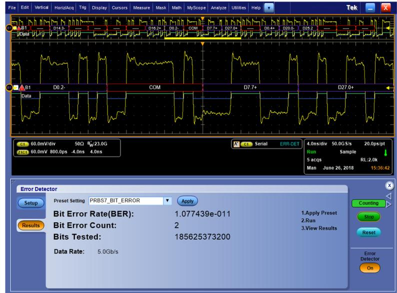
**注意。** 如果因為某些原因，錯誤偵測器遺失訊號源上的鎖定(例如：訊號源從輸入移除)，同步將會遺失。發生這種情況時，因為觸發系統不再同步，所以示波器的波形擷取將在自由執行中操作。如果要將觸發系統重新同步至訊號源並解決此問題，從主功能表選取「Edit > Clear Data」(編輯 > 清除資料)。這將會強制觸發系統重新與訊號源同步，讓您可以繼續一般操作。
