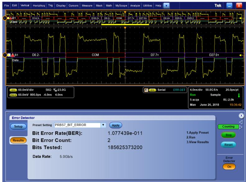
**注:** 何らかの理由により(信号が入力から取り除かれたなど)エラー・ディテクタが信号にロックできなくなった場合は、同期も失われます。この場合、トリガ・システムがすでに同期していないため、オシロスコープの波形取込みはフリーラン・モードで実行されます。トリガ・システムを信号に同期させ、この問題を解消するには、メイン・メニューから Edit (編集) > Clear Data (データのクリア) を選択します。トリガ・システムを強制的に信号に再同期させるため、通常の動作が回復します。
