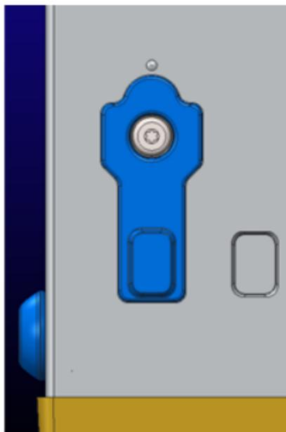
2 台の機器を単純に積み重ねて使用する場合は、脚を 180 度回転させます。
