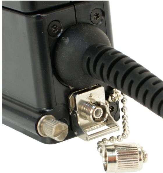
**Abbildung 9: Entfernen der Metallstaubschutzkappe vom optischen Anschluss**
