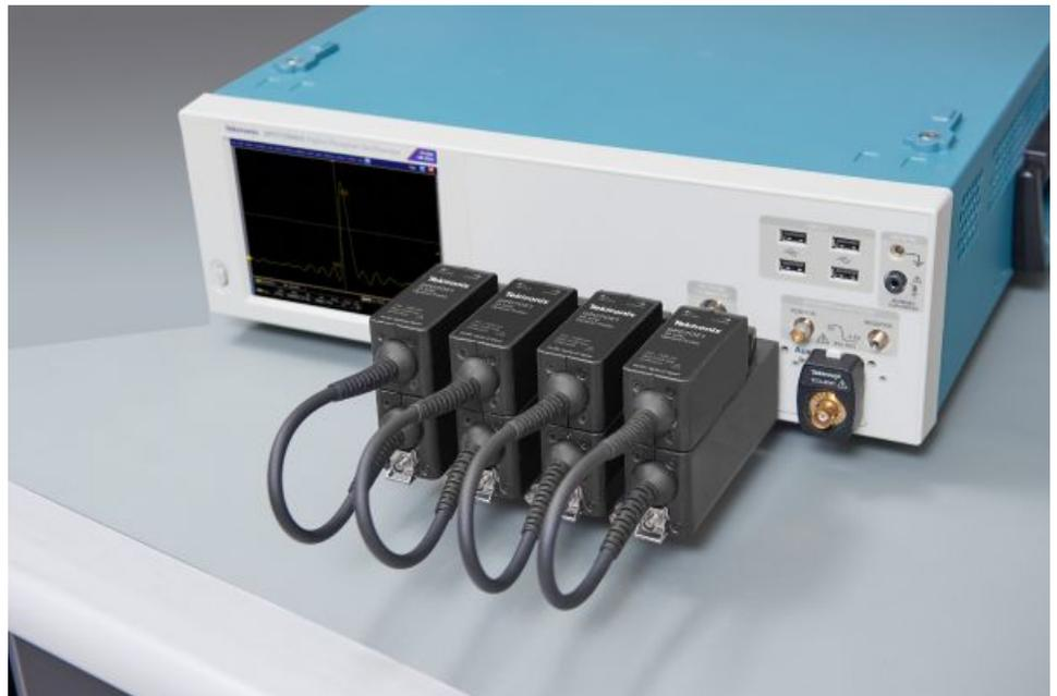
**Abbildung 3: Die DPO7OE-Serie unterstützt mehrere optische Eingänge und Mehrfach-Träger-Konfigurationen**
