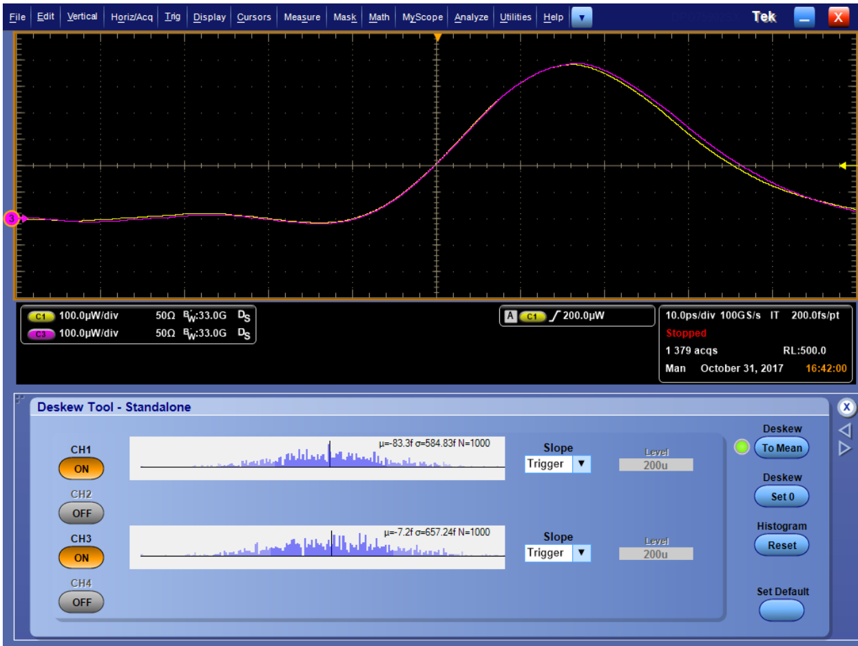
图 15: 最终相差校正过波形的示例
