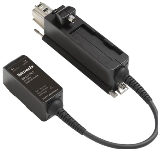
**圖表 2: DPO70E 系列與從載體拆卸下來的套筒**
