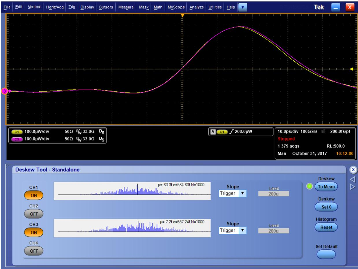
圖表 15: 最終偏移校正后波形的範例
