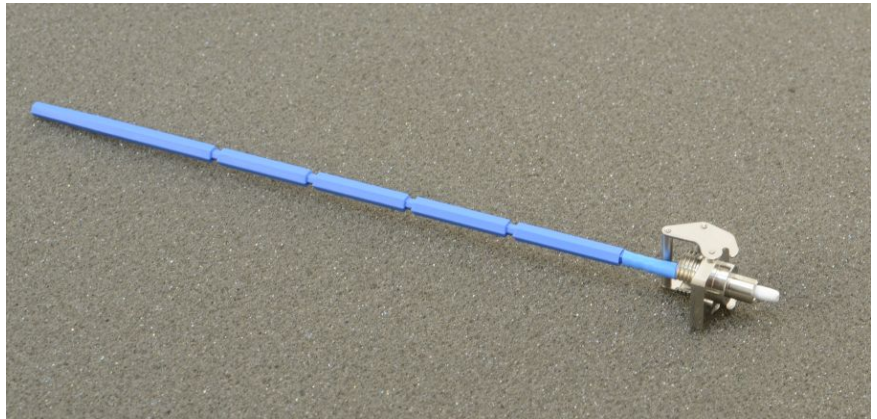
Abbildung 11: Reinigen des JAE-Anschlusses
