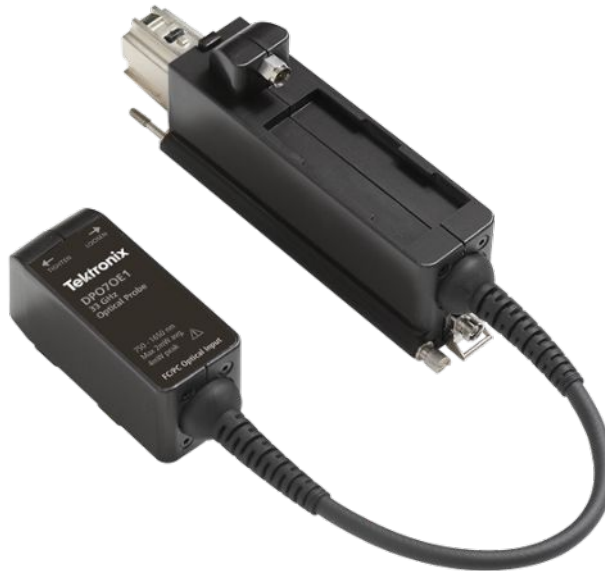
Abbildung 2: DPO7OE1 mit vom Träger getrenntem Shuttle
